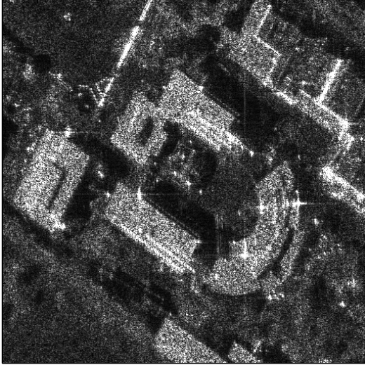
(a) Image RSO SLC originale (amplitude) extraite de la ville d'Hyeres. ©ONERA.
