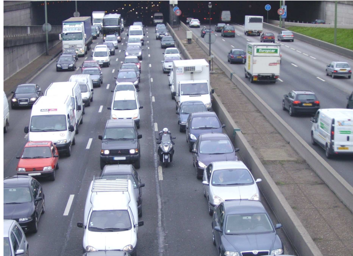
Figure 5 : Exemple de surlageur 61 entre la troisième et la quatrième voie d'une autoroute urbaine favorisant des manœuvres rapides de circulation entre files par les deux-roues à moteur ( Cliché de l'auteur )
