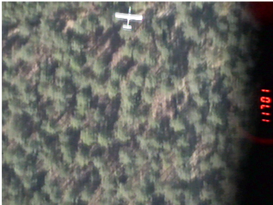
Figure IV.7 Image issue de la caméra vidéo embarquée avec AirFLEX. Le numéro incrusté à droite correspond précisément à une acquisition d'AirFLEX faite au moment où l'image a été enregistrée : il est ainsi possible d'associer une mesure à une image représentant la cible.
