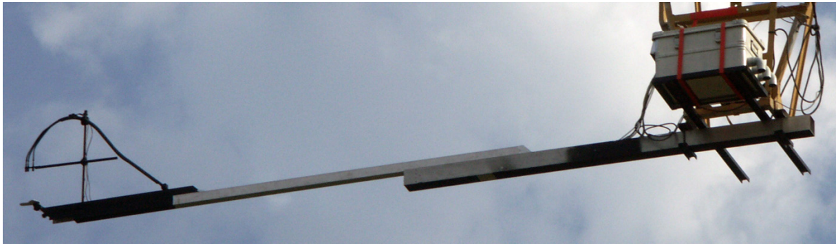
Figure V.10 Instrument TriFLEX. A droite la boîte en aluminium contenant l'électronique, peinte en blanc afin de limiter l'influence du rayonnement solaire sur la température à l'intérieur de la boîte. A gauche la tête optique, déportée d'environ 5 mètres par rapport à l'électronique afin d'éviter de perturber l'environnement lumineux de la mesure sur la référence.
