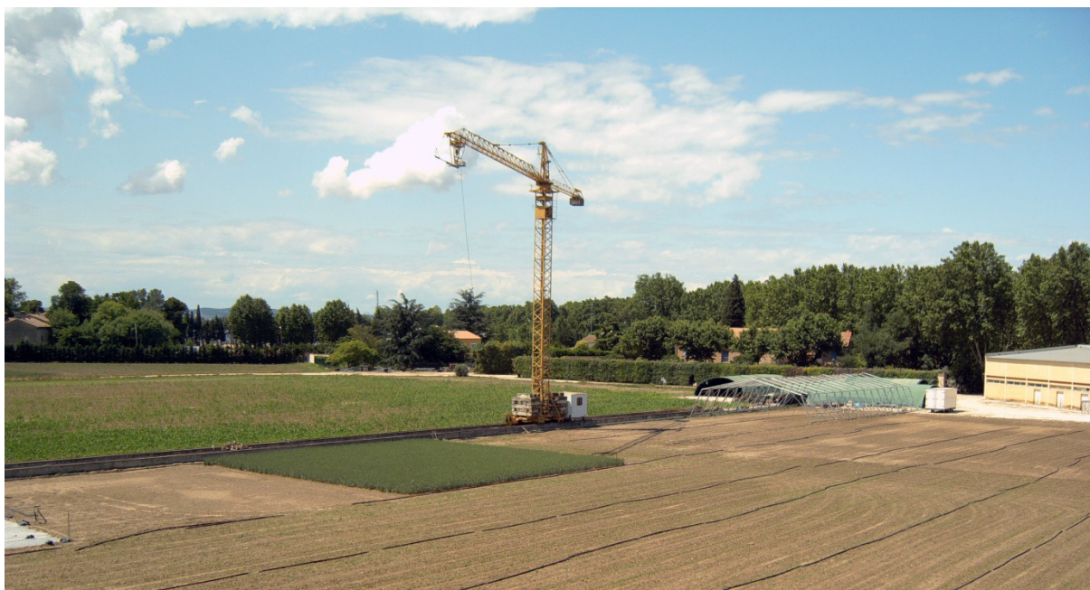
Figure V.2 Le site de l'INRA. Vue de la grue avec l'instrument TriFLEX (voir sections suivantes). Le faisceau de câbles reliant TriFLEX à la base de la grue permet d'amener le courant et le réseau jusqu'à l'instrument.
