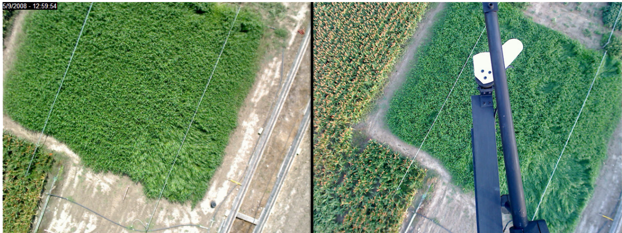
Figure V.13 Vue des deux webcams utilisées par TriFLEX. A gauche webcam de suivi de la cible, à droite webcam de contrôle de la référence. La cible est une parcelle de sorgho fourrager.
