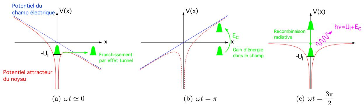
FIGURE 1.9 – Le modèle de génération d'harmonique à 3 étapes : (a) ionisation tunnel, (b) accélération de l'électron dans le champ et (c) recombinaison sur l'état fondamental avec émission d'un photon
