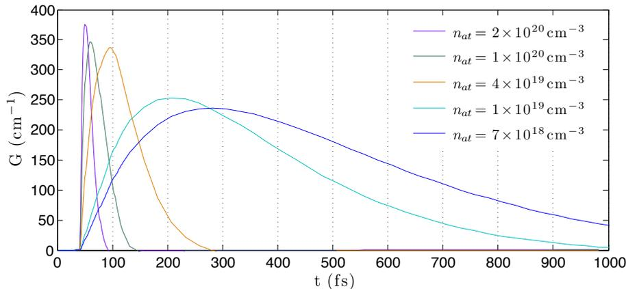
FIGURE 6.1 – Allure temporelle du gain de l'amplificateur pour de fortes densités de krypton. À titre de comparaison, une pression de 30 mbar correspond à une densité atomique de  $7.4 \times 10^{17} \text{ W/cm}^2$
