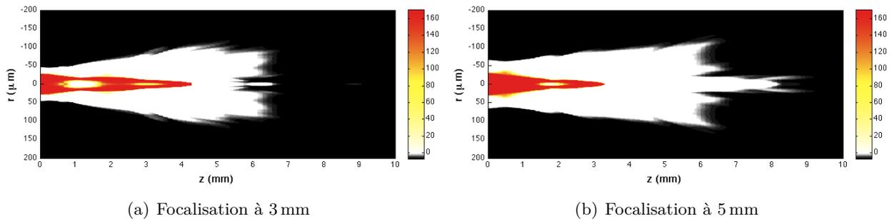
FIGURE 3.14 – Cartes de gain et d'absorption du plasma pour une longueur de cellule de 10 mm ( $P_{Kr} = 30$  mbar et  $I_{pompe} = 10^{18}$  W/cm<sup>2</sup>)
