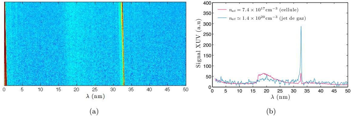
FIGURE 6.17 – (a) Spectre XUV obtenu par guidage de l'impulsion pompe à une densité atomique de  $1.4 \times 10^{20}$ . (b) Coupe transversale et comparaison au spectre obtenu à une pression de 30 mbar, en cellule. Un filtre en aluminium a été utilisé, expliquant la coupure du spectre à 17 nm
