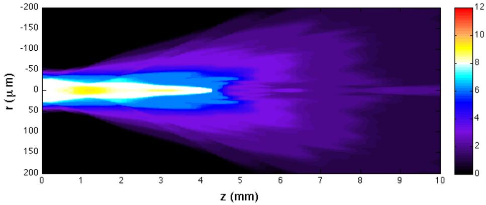
FIGURE 3.13 – Carte d'ionisation du plasma après le passage de l'impulsion laser calculée pour une pression de krypton de 30 mbar et une intensité de pompe dans le vide de  $10^{18}$  W/cm<sup>2</sup>
