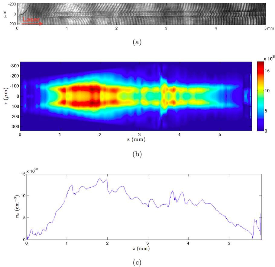
FIGURE 6.18 – (a) Interférogramme du plasma créé par guidage de l'impulsion pompe dans le canal préformé et (b) la carte de densité électronique correspondante. (c) donne la densité moyenne dans le canal le long du jet
