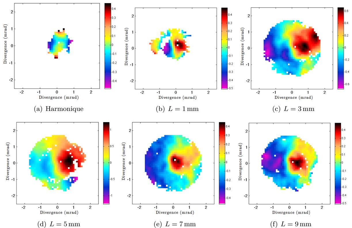
FIGURE 4.11 – Mesure du front d'onde du faisceau injecté pour différentes longueurs de cellule
