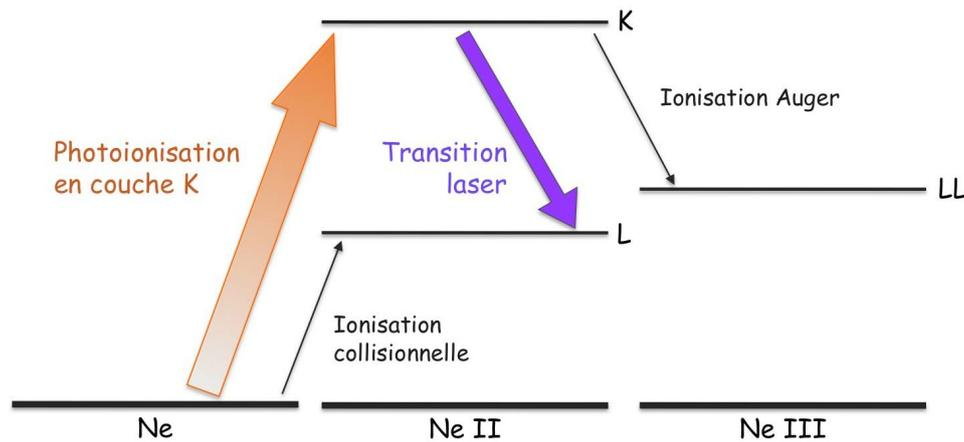
FIGURE 1.21 – Principe du schéma de pompage par photoionisation en couche interne pour le néon : un électron est arraché en couche  $K$  et le trou créé est comblé par désexcitation d'un électron en couche  $L$ . La transition est associée à une longueur d'onde de  $15\text{\AA}$
