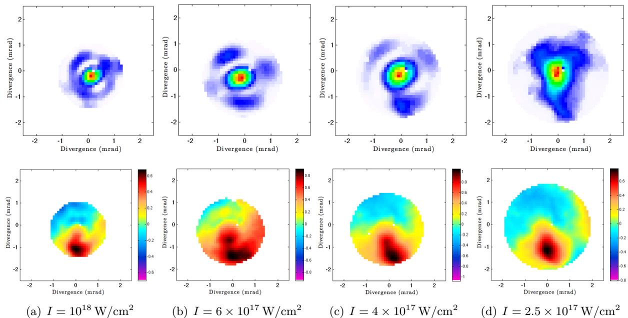
FIGURE 4.27 – Mesure du front d'onde du faisceau injecté pour différentes intensités de pompe
