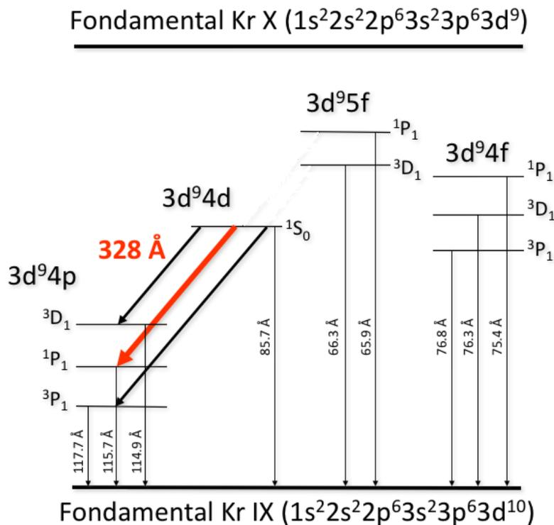
FIGURE 2.1 – Schéma des niveaux de l'ion krypton nickelloïde
