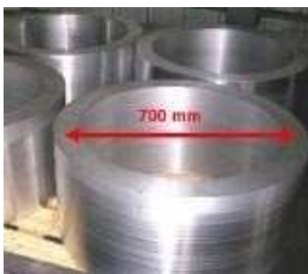
Figure 1 : Virole centrale du caisson-cœur du Réacteur expérimental Jules Horowitz avant soudage et usinage.
