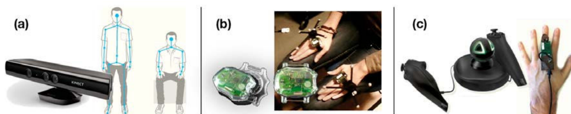
Figure 2-10 : Capteurs grand public. (a) Caméra de profondeur Microsoft Kinect , (b) Bracelet à centrale inertielle Movea MotionPod , (c) Manette à capteur magnétique Razer Hydra et modification possible
