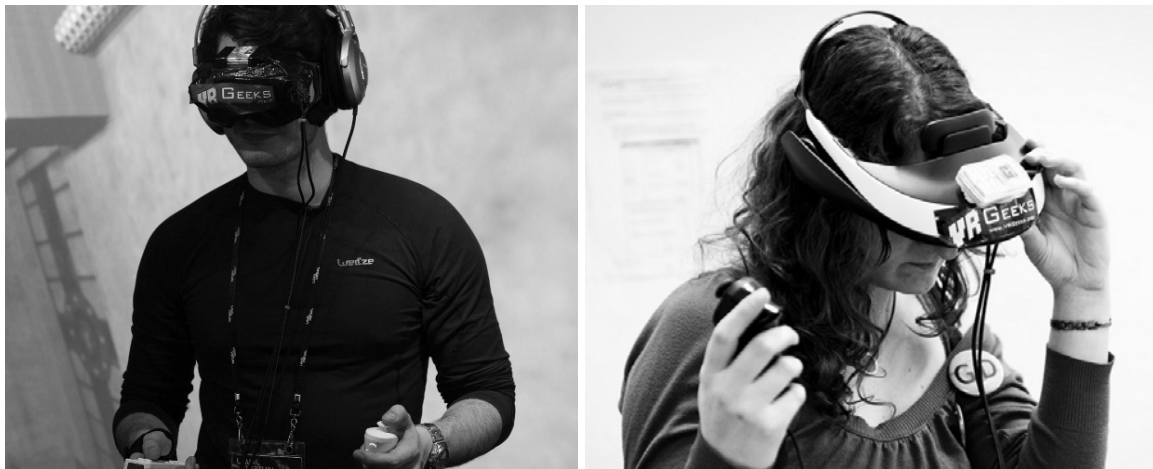
Figure 1-3 : Deux utilisateurs en immersion et interaction avec des dispositifs à bas coûts : à gauche casque Vuzix VR920, Gametrak et Wiimote / à droite casque Sony HMD, SpacePoint Fusion et Razer Hydra. Photos de l'association VRGeeks extraites de (Kuntz et al. 2012)
