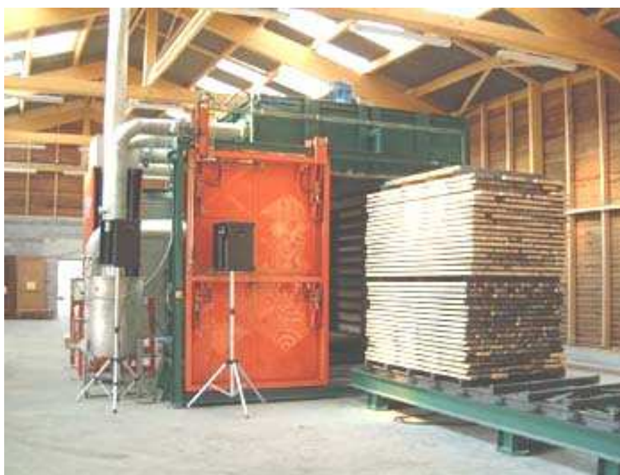
Photo I. 1 : Four REY de la société RETIMAC à Rodez. Au premier plan la pile de bois traité prête à être déchargée
