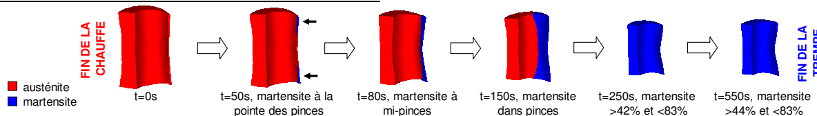
Figure VI - 19 : Evolution des amplitudes des phénomènes de déformations aux instants clés de la formation de la martensite dans le croissant, nuance 1, trempé huile
