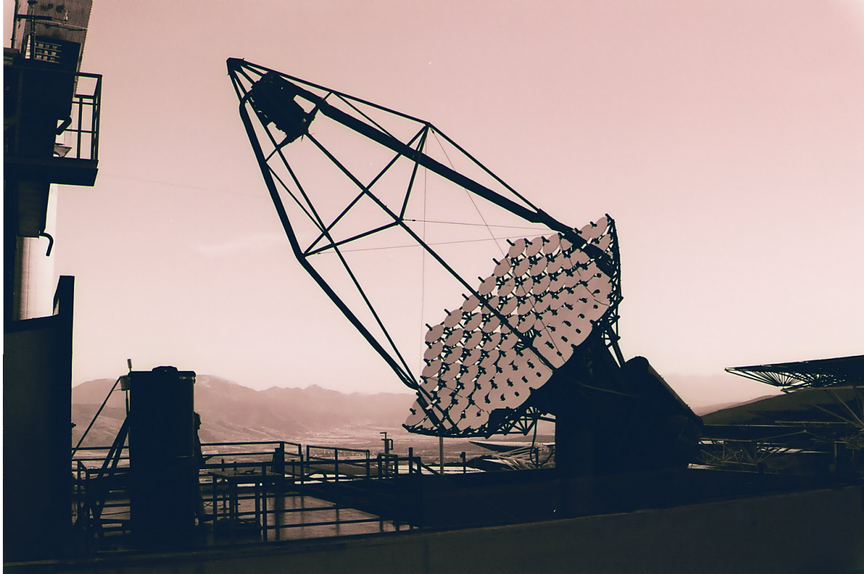
FIG. 3.2: L'imageur CAT photographié juste avant le coucher de Soleil, qui envoie encore ses rayons sur la tour (visible dans la partie gauche de la photo). Le hangar est ouvert, le télescope est en élévation au dessus de sa position de repos. On voit bien le réflecteur composé de 90 miroirs individuels, et la caméra dans son plan focal.
