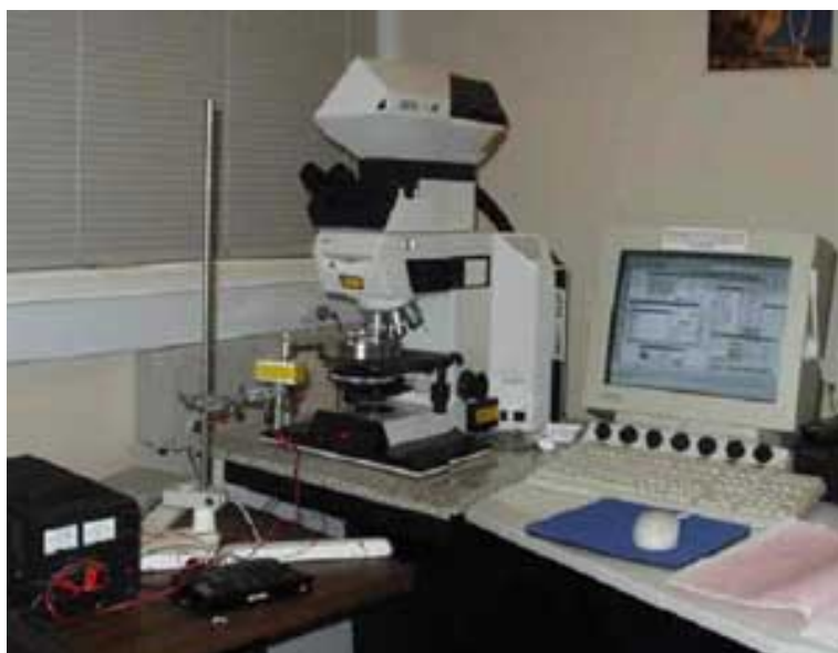
FIG. B.8: Cellule de cisaillement sous un microscope confocal.
