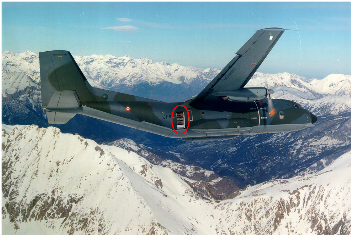
Figure 156 – Capteur RAMSES et son porteur : le Transall
