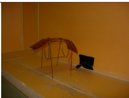
Figure 4.20 Résistance électrique à l'intérieur de la cellule
