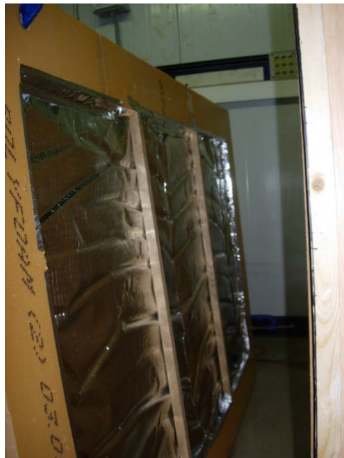
Figure 4.31 - Montage du PMR couplé à une lame d'air
