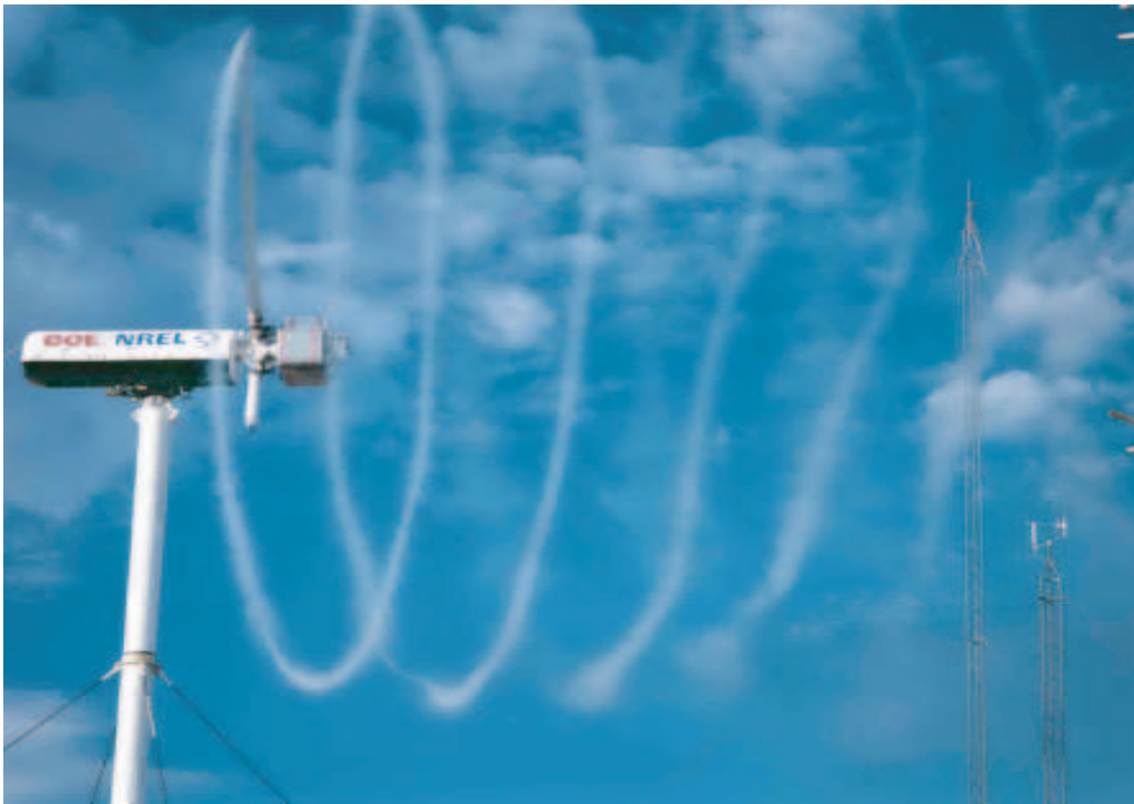
FIGURE 2.2 – Visualisation du sillage d'une éolienne par la fumée, [NREL]
