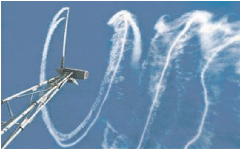
FIGURE 1.2 – Expérience réalisée par le Centre danois de recherche sur l'énergie "Risø", montrant le sillage d'une éolienne à une seule pale [63].
