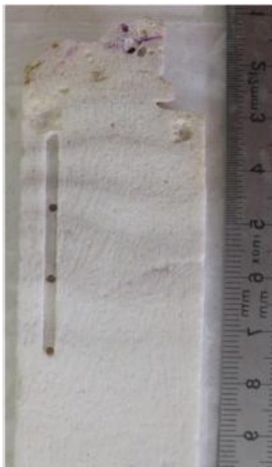
Figure 4.1: Échantillon moderne NC94. Trace des prélèvements à la microperceuse sur la tranche N°2 pour l'analyse ICP-MS. Pour chaque prélèvement, le foret à un diamètre de 1mm. Le transept comprend 60 points de mesure collectés du haut vers le bas de la figure avec un pas d'avancement de 0.6 mm (voir Fig. 2.13). Tous les 20 points, le foret est enfoncé plus profond dans la tranche de corail après prélèvement, d'où les 3 « trous » nettement visibles dont nous verrons plus loin l'utilité.
