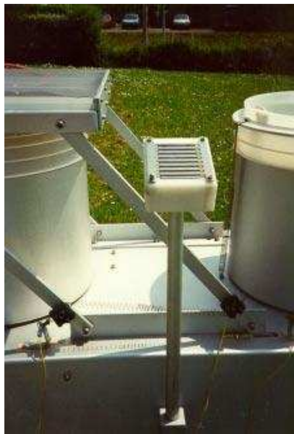
Figure I.4 : Dispositif de détection de la pluie et d'enregistrement des basculements du couvercle
