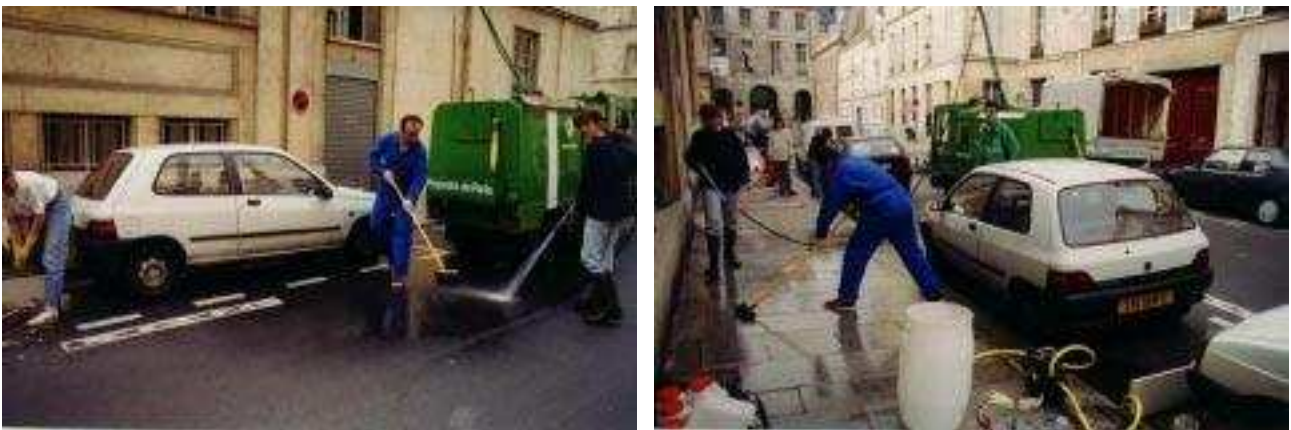
Figure I.9 : Echantillonnage des dépôts de rues à l'aide d'un jet d'eau sous pression et de la collecte des eaux de ruissellement dans un réceptacle à l'aide d'une pompe
