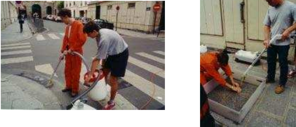
Figure I.8 : Echantillonnage des dépôts de rues à l'aide de la technique mis au point par Bris et al. (1999)
