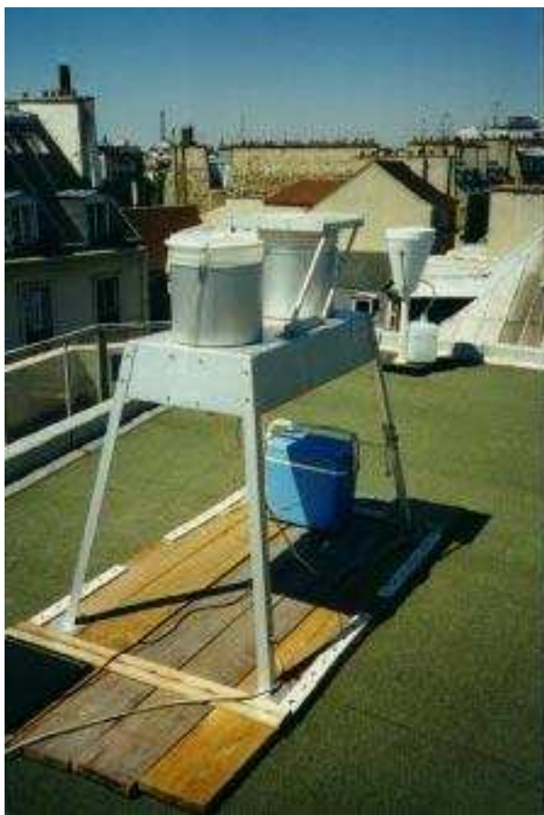
Figure I.3 : Préleveur ARS 1 000 à Paris sur le toit de la crèche (symbolisé par le sigle ● de la Figure I.1)
