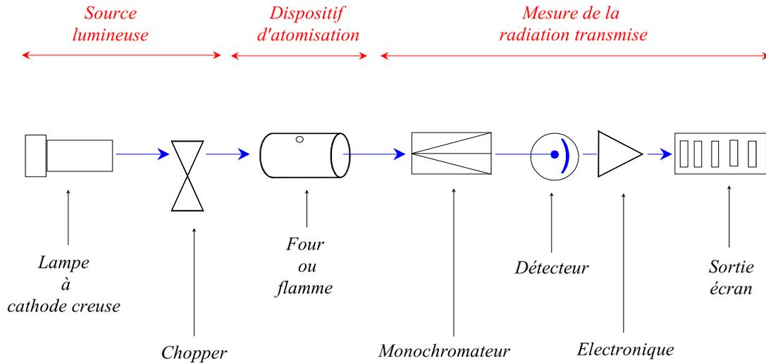
**Lampe à cathode creuse** fournissant le spectre d'émission de l'élément à doser
