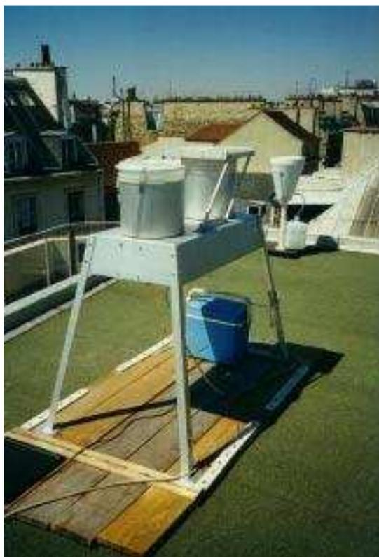
Fig. 3. Echantillonneur "ARS 1000"
