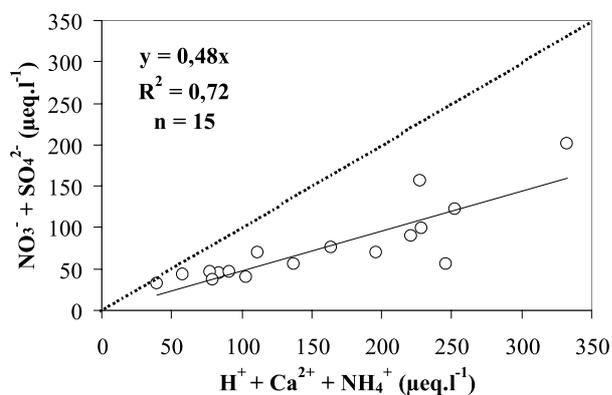
Figure II.15 : Relation entre les concentrations d'anions ( $\text{NO}_3^- + \text{SO}_4^{2-}$ ) et de cations ( $\text{H}^+ + \text{Ca}^{2+} + \text{NH}_4^+$ ) dans 15 échantillons de retombée humide prélevés à Paris du 21/05/96 au 22/10/97
