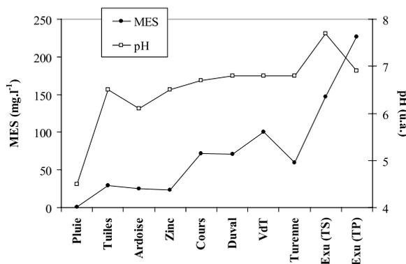
**Figure IV.11 :** Concentrations de MES et valeurs de pH dans les eaux de ruissellement : comparaison avec l'eau de pluie et les eaux de temps sec à l'exutoire
