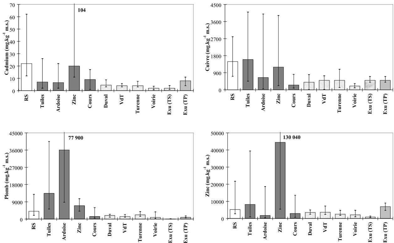
Figure IV.12 : Teneurs de Cd, de Cu, de Pb et de Zn dans les eaux de ruissellement : comparaison avec les retombées atmosphériques sèches et les eaux de temps sec : médiane, déciles inférieur et supérieur
