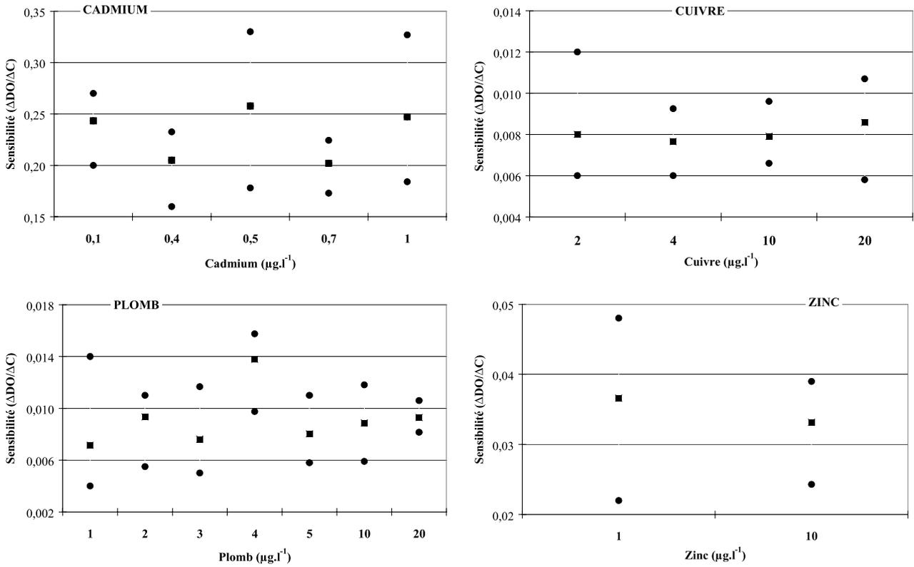
Figure I.11 : Sensibilité du spectrophotomètre d'absorption atomique en fonction de la concentration du standard (valeurs moyennes, minimales et maximales ; n varie de 3 à 16 gammes d'étalonnage)
