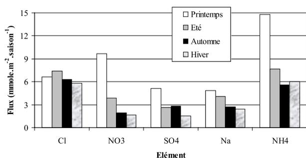
**Figure II.23 :** Evolution saisonnière des flux humides de chlorures, de nitrates, de sulfates, de sodium, et d'ammonium à Paris du 29/05/96 au 01/07/97 (valeurs calculées sur l'ensemble de la saison)
