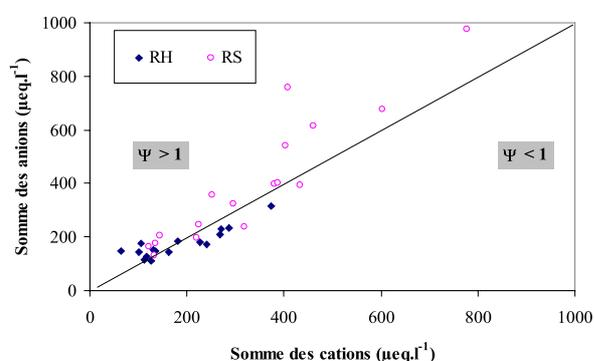
**Figure II.13 :** Balance ionique ( $\Sigma_{\text{anions}}/\Sigma_{\text{cations}}$ ) des échantillons de retombées humides (RH) et sèches (RS) prélevés à Paris du 21/05/96 au 01/07/97, et droite théorique  $\Psi = 1$
