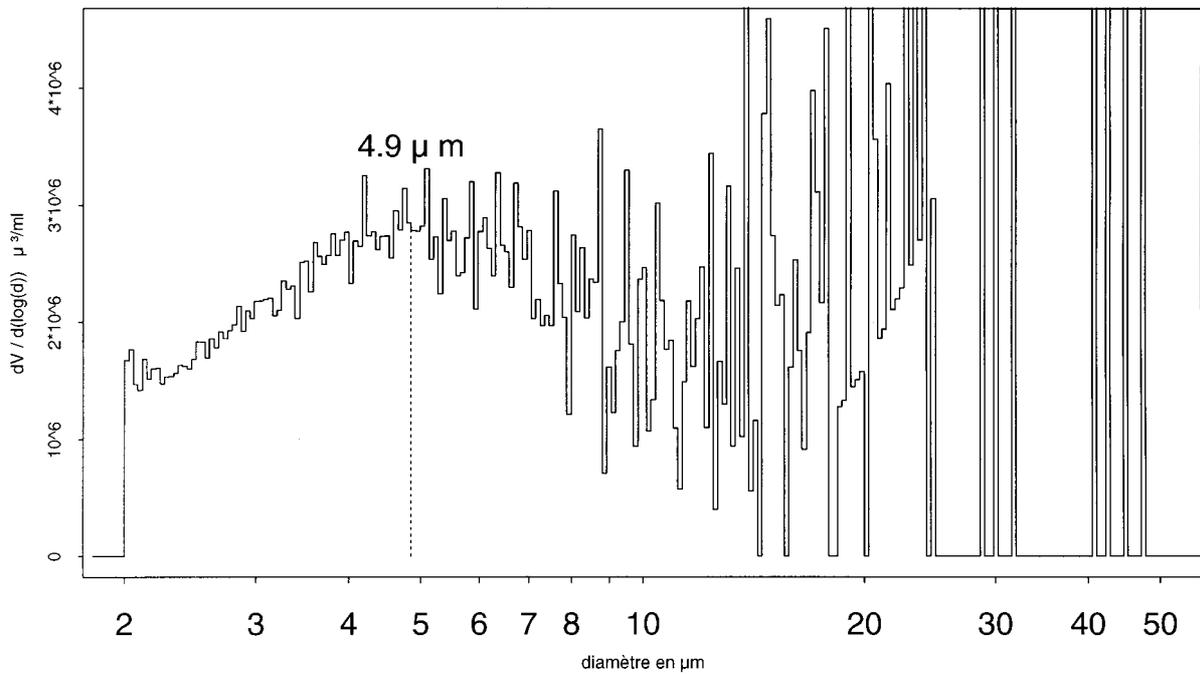
Figure II.28 : Spectre granulométrique typique d'un échantillon de retombée humide à Paris : prélèvement du 07/10/96 au 16/10/96
