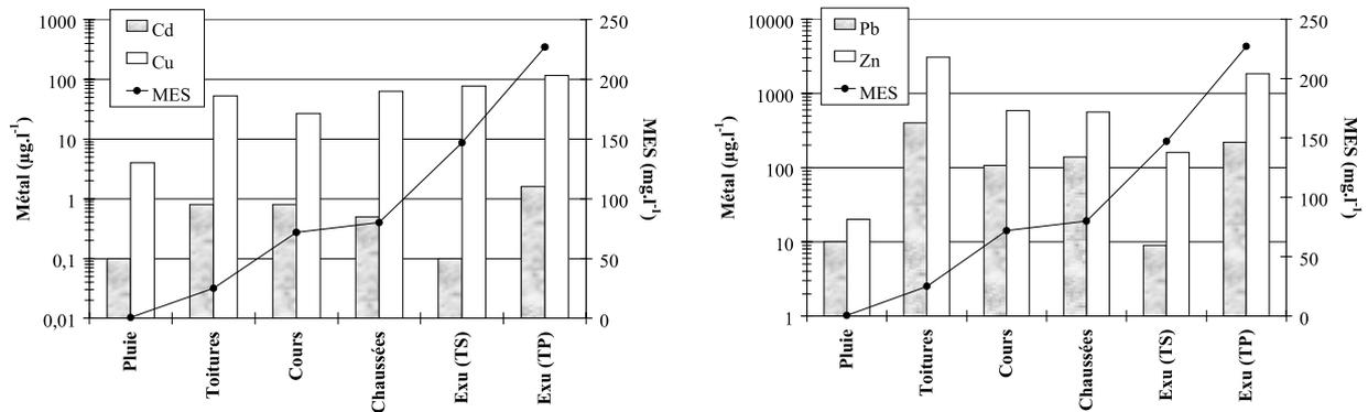
Figure IV.16 : Evolution des médianes des concentrations totales en MES ( $mg.l^{-1}$ ) et des concentrations de Cd, de Cu, de Pb et de Zn de l'amont à l'aval du bassin versant urbain expérimental du Marais à Paris (échelle logarithmique,  $\mu g.l^{-1}$ )
