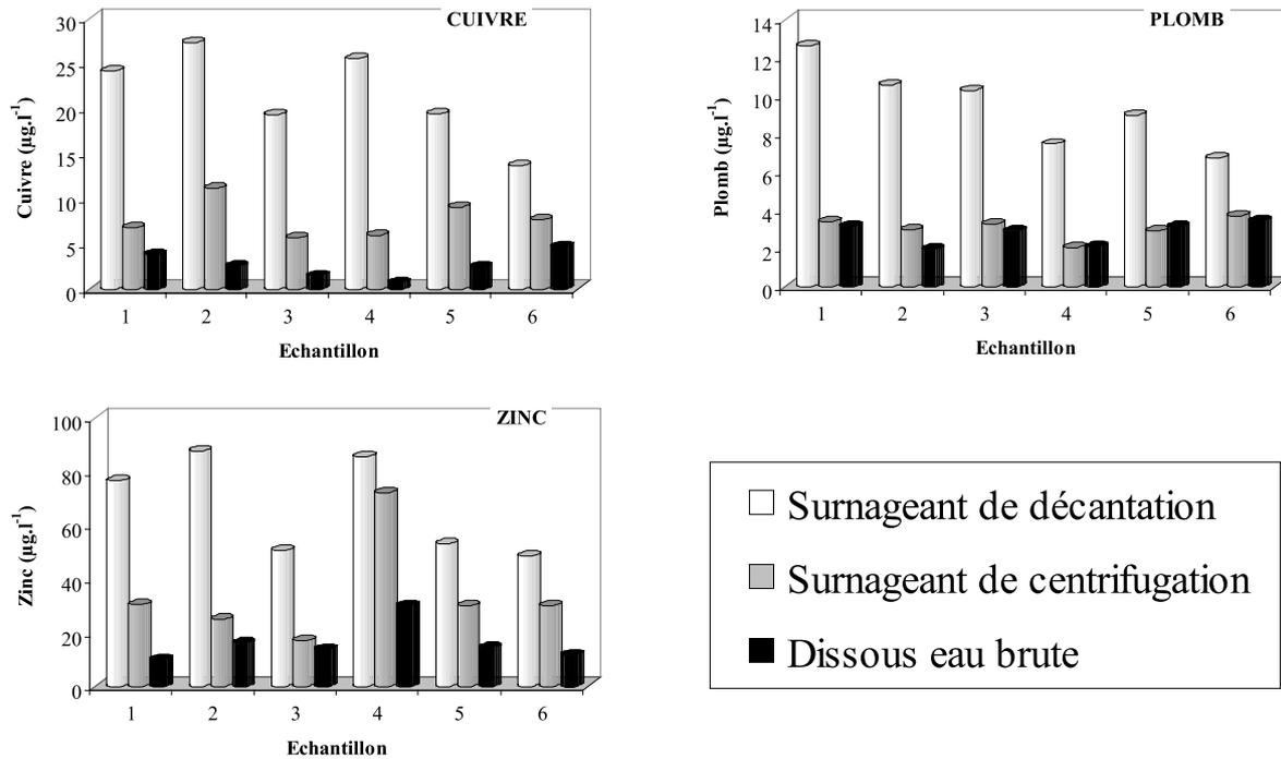
**Figure I.14 :** Concentrations de cuivre, de plomb et de zinc dans les surnageants de décantation et de centrifugation et dans le filtrat d'eau usée (les durées de décantation en cône Imhoff des échantillons 1 à 6 sont respectivement de 2, 3, 3, 3, 4 et 5 heures)
