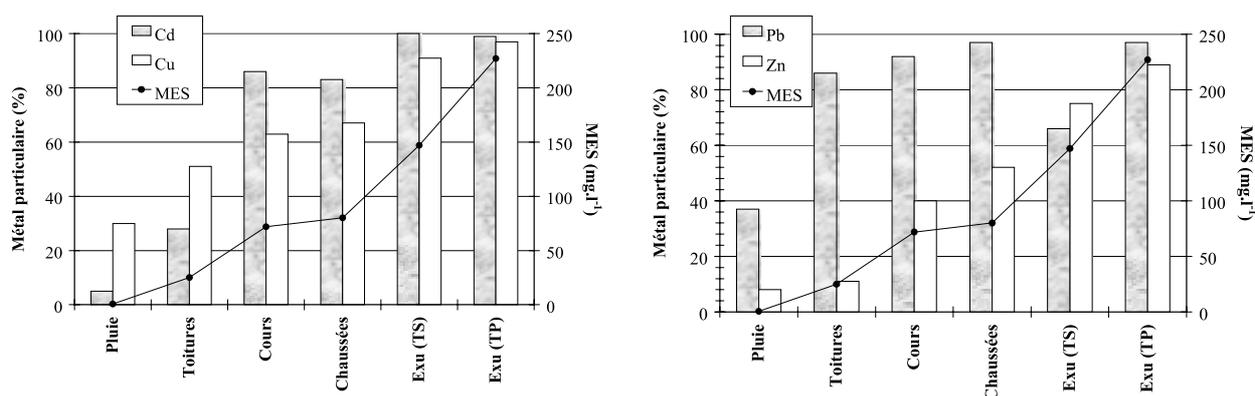
**Figure IV.18 :** Evolution de la médiane de la concentration en MES ( $mg.l^{-1}$ ) et du pourcentage de Cd, de Cu, de Pb et de Zn sous forme particulaire de l'amont à l'aval du bassin versant urbain expérimental du Marais à Paris (%)
