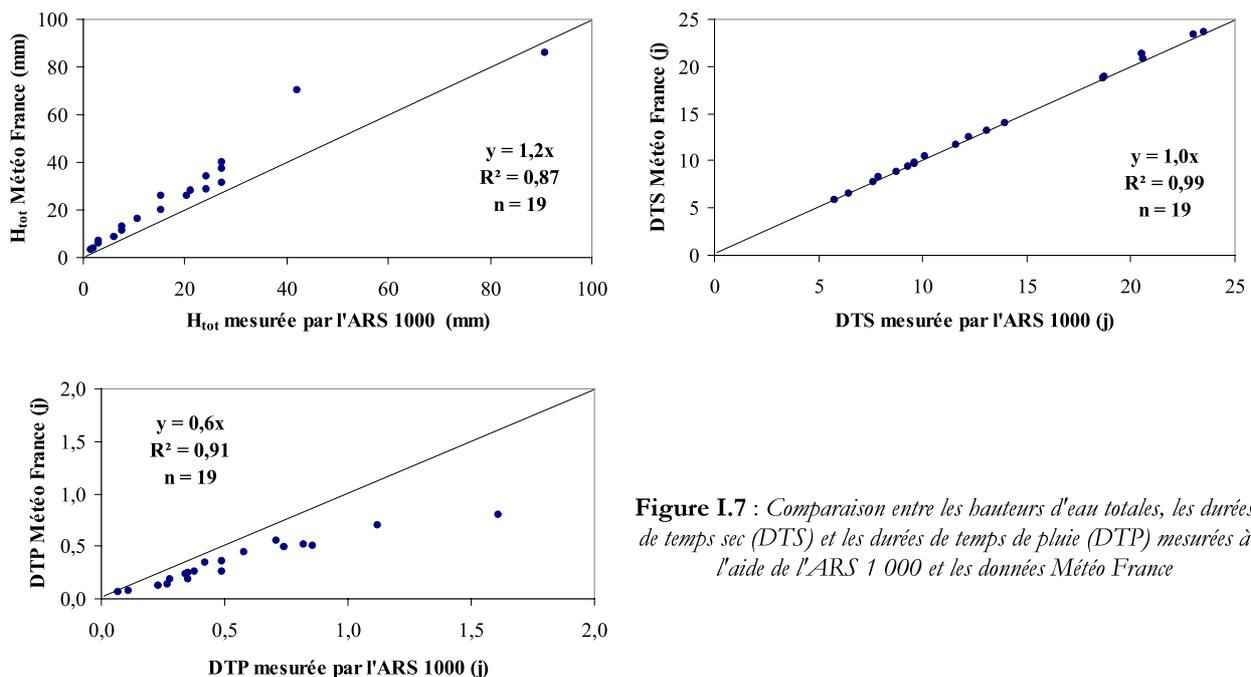
**Figure I.7 :** Comparaison entre les hauteurs d'eau totales, les durées de temps sec (DTS) et les durées de temps de pluie (DTP) mesurées à l'aide de l'ARS 1 000 et les données Météo France
