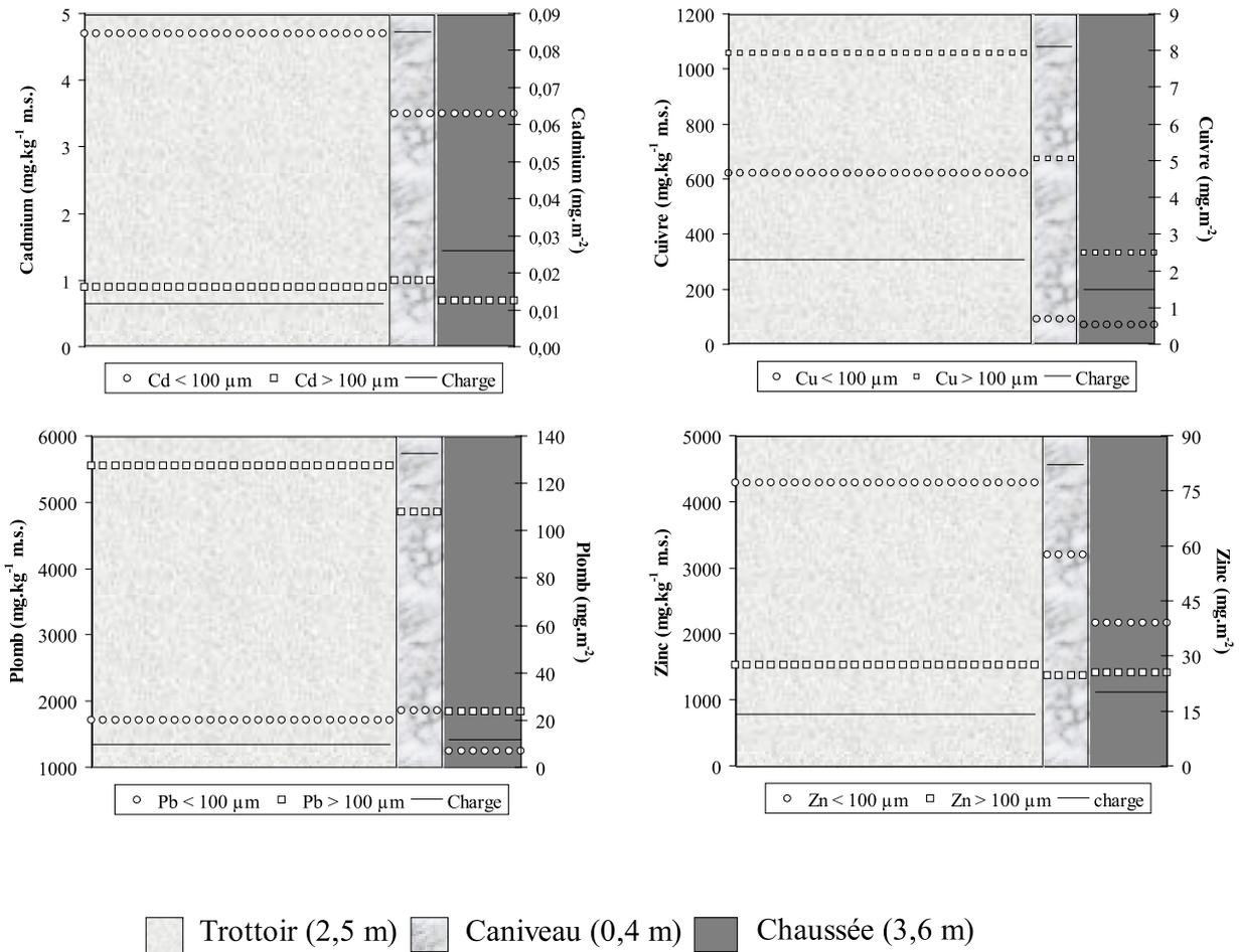
Figure III.1 : Teneur et charge surfacique moyenne de cadmium, de cuivre, de plomb et de zinc mesurées sur les trois surfaces de la rue de Béarn à Paris (valeurs moyennes ; n = 6)
