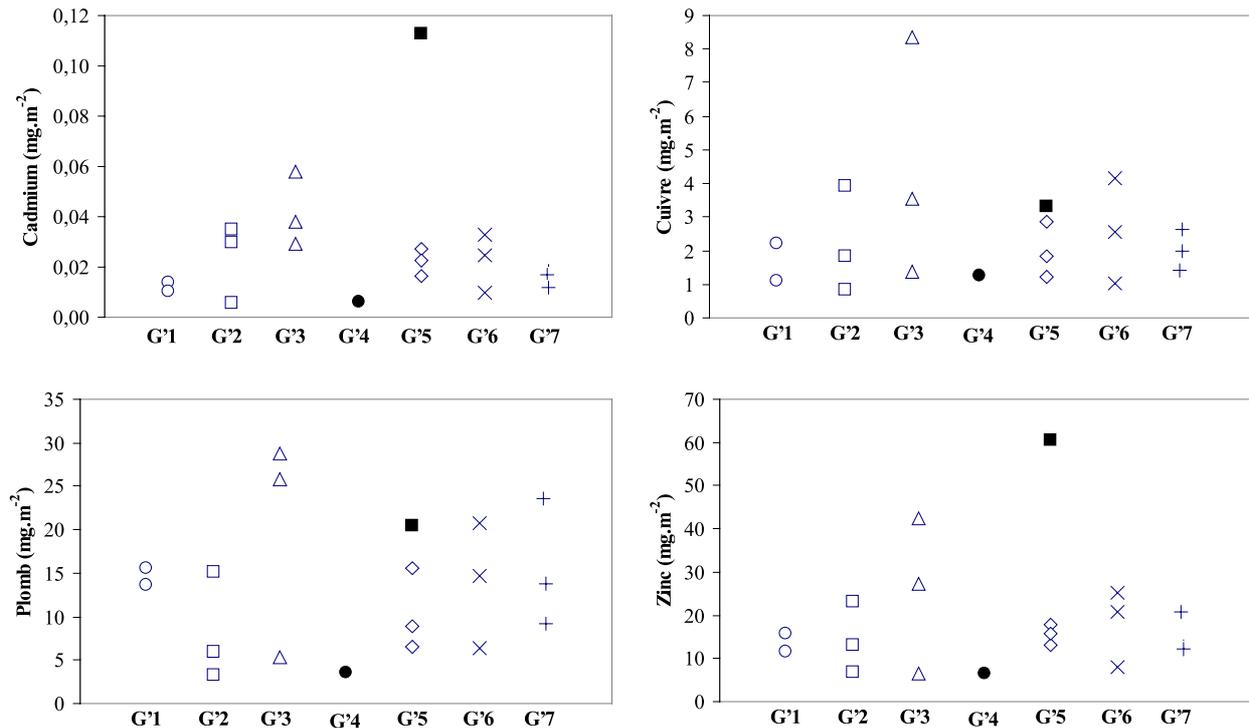
**Figure III.3 :** Charges surfaciques de cadmium, de cuivre, de plomb et de zinc dans les sept groupes de rues du Bassin Versant Urbain Expérimental du Marais à Paris : le nombre d'échantillon et les caractéristiques des différents groupes sont listées au Tableau III.6 ; les charges surfaciques obtenues par la méthode de Bris *et al.* (1999) sont mentionnées sur le graphique (■ dans le groupe G'5)
