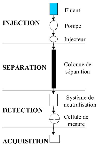
Figure I.24 : Schéma de principe de la chromatographie ionique (selon Peschet et Tinet, 1986)
