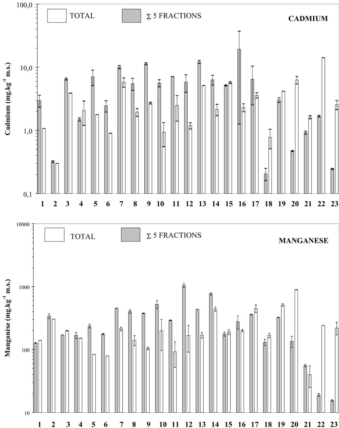
Figure I.23 : Comparaison des teneurs particulières de cadmium et de manganèse mesurées par minéralisation et en effectuant la somme des 5 extractions séquentielles (moyenne  $\pm$  dispersion ;  $n = 23$ )
