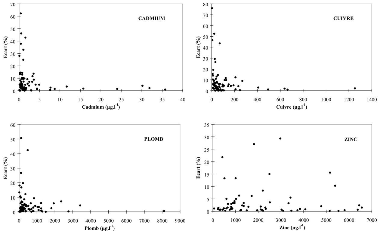
**Figure I.25 :** Distribution des dispersions entre les duplicats de digestion acide en fonction de la concentration métallique totale de l'échantillon (exprimées en pourcentage par rapport à la valeur moyenne ,  $n = 80$ )
