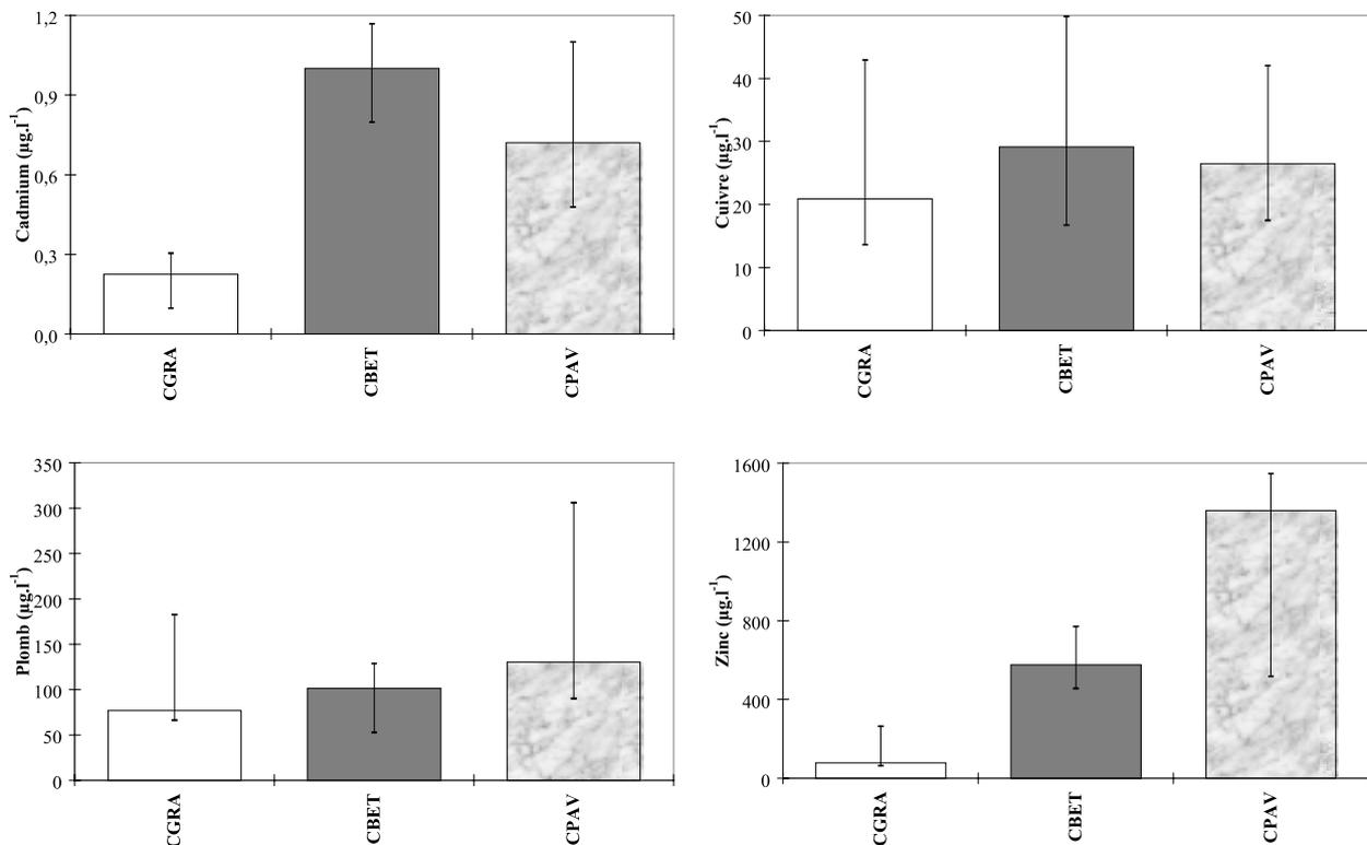
Figure IV.8 : Concentrations totales de Cd, de Cu, de Pb et de Zn mesurées dans les eaux de ruissellement de cours internes de nature différente : médiane, déciles inférieur et supérieur (voir Tableau IV.12 pour la signification des sigles)
