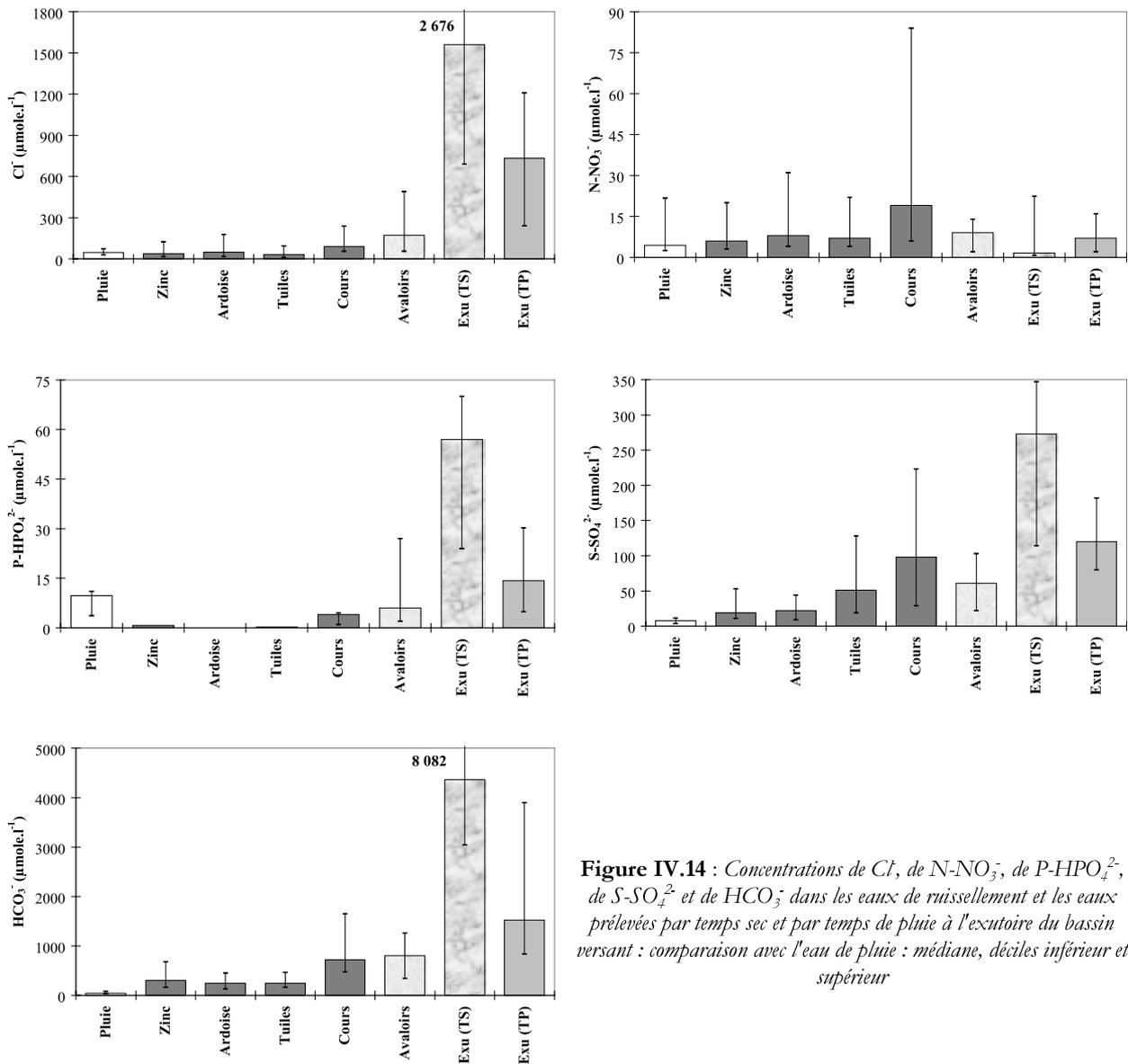
**Figure IV.14** : Concentrations de  $\text{Cl}^-$ , de  $\text{N-NO}_3^-$ , de  $\text{P-HPO}_4^{2-}$ , de  $\text{S-SO}_4^{2-}$  et de  $\text{HCO}_3^-$  dans les eaux de ruissellement et les eaux prélevées par temps sec et par temps de pluie à l'exutoire du bassin versant : comparaison avec l'eau de pluie : médiane, déciles inférieur et supérieur
