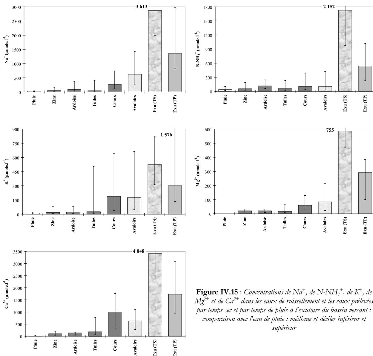
**Figure IV.15 :** Concentrations de  $\text{Na}^+$ , de  $\text{N-NH}_4^+$ , de  $\text{K}^+$ , de  $\text{Mg}^{2+}$  et de  $\text{Ca}^{2+}$  dans les eaux de ruissellement et les eaux prélevées par temps sec et par temps de pluie à l'escutoire du bassin versant : comparaison avec l'eau de pluie : médiane et déciles inférieur et supérieur
