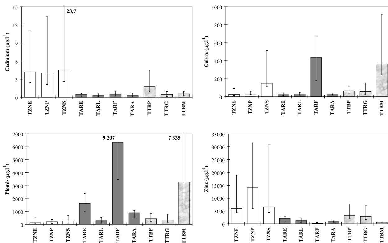
**Figure IV.7 :** Concentrations totales de Cd, de Cu, de Pb et de Zn mesurées dans les eaux de ruissellement des différentes toitures : médiane, déciles inférieur et supérieur (voir Tableau IV.12 pour la signification des sigles)
