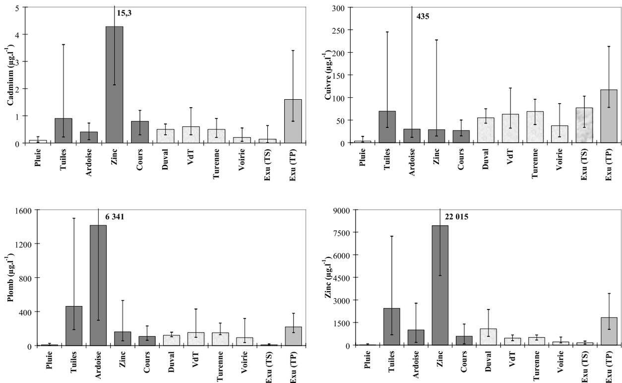
**Figure IV.6 :** Concentrations totales de Cd, de Cu, de Pb et de Zn dans les eaux de ruissellement et à l'exutoire du bassin versant du Marais par temps de pluie : comparaison avec les concentrations mesurées dans la pluie, les eaux de ruissellement et les eaux usées de temps sec (médiane et déciles inférieur et supérieur ;  $\mu\text{g.l}^{-1}$ )
