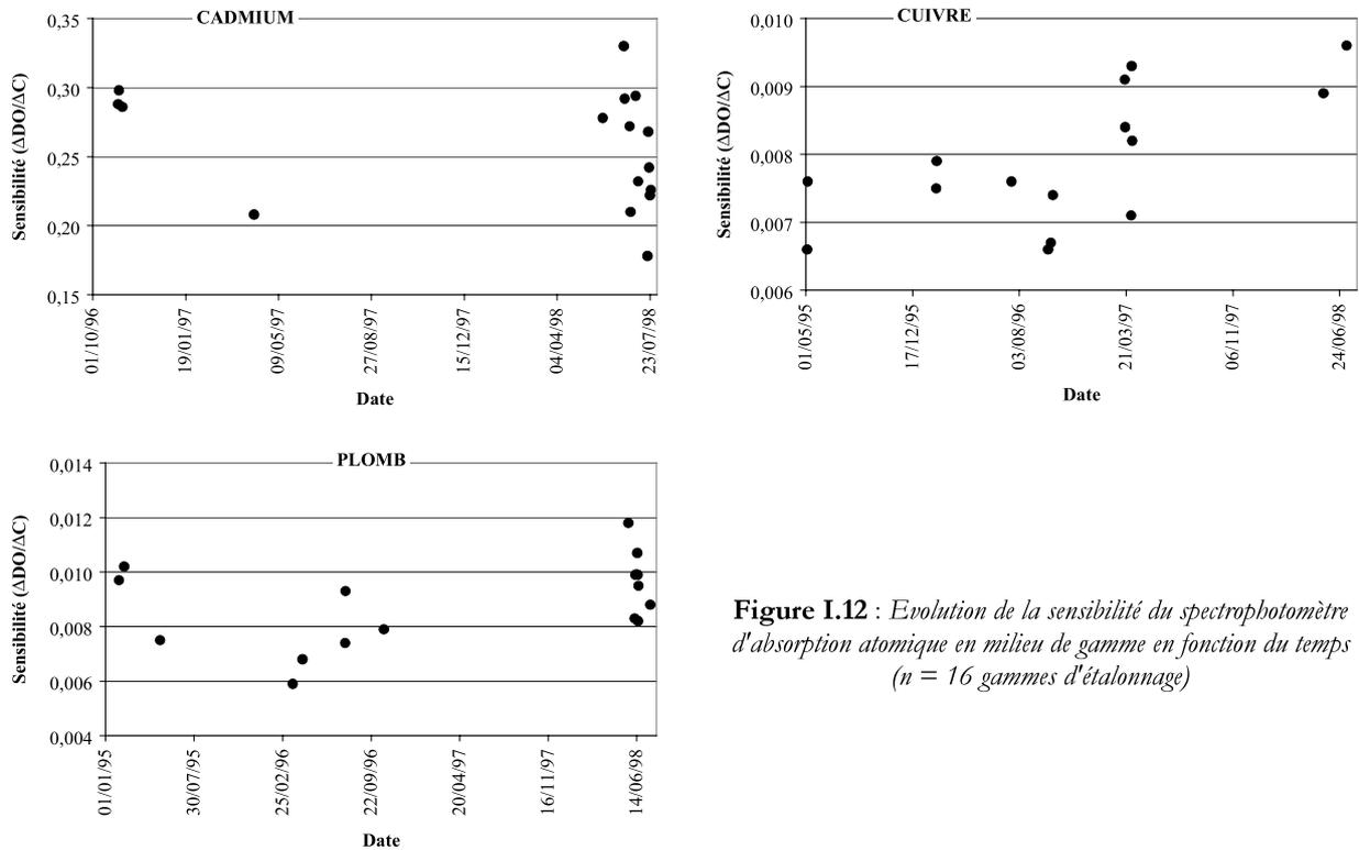
Figure I.12 : Evolution de la sensibilité du spectrophotomètre d'absorption atomique en milieu de gamme en fonction du temps (n = 16 gammes d'étalonnage)
