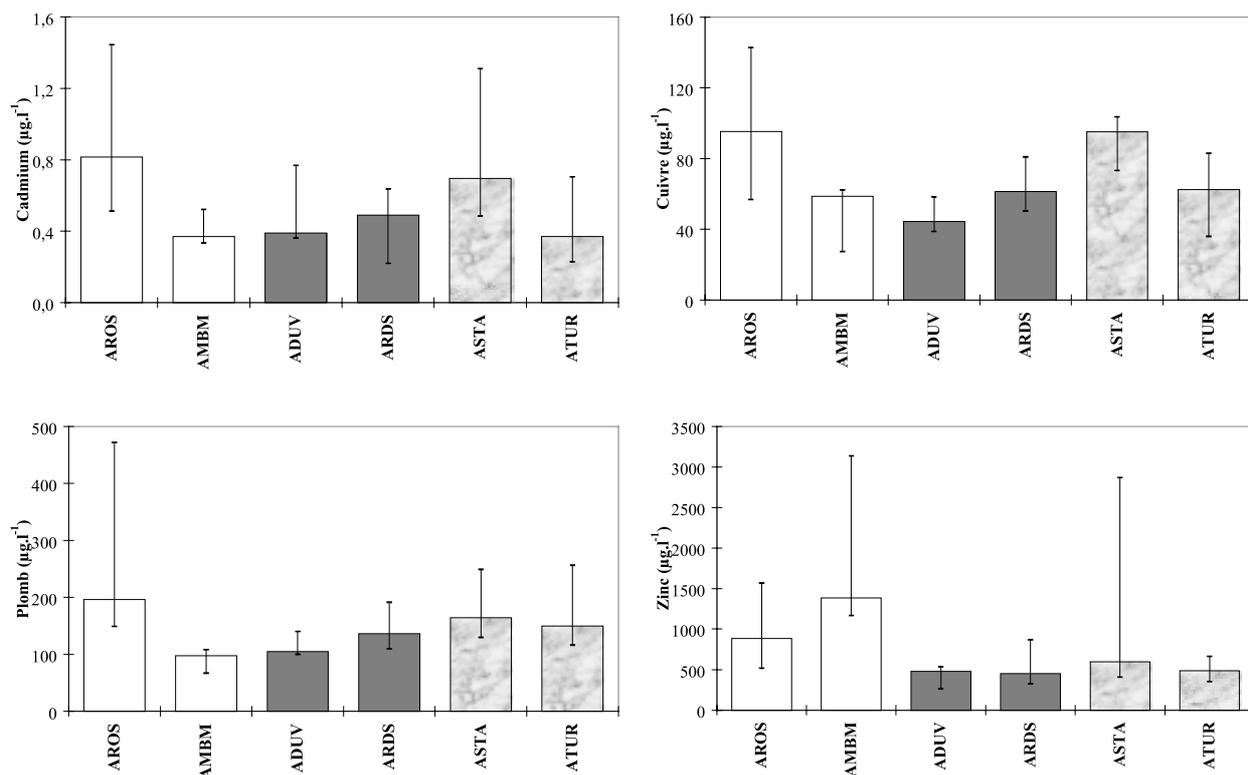
Figure IV.9 : Concentrations totales de Cd, de Cu, de Pb et de Zn mesurées dans les eaux de ruissellement de chaussées de nature différente : médiane, déciles inférieur et supérieur (voir Tableau IV.12 pour la signification des sigles)
