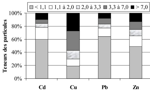
**Figure II.26 :** Distribution en volume du Cd, du Cu, du Pb et du Zn en fonction de la taille des particules (d'après Juguet et al., 1984 pour les cas du Pb et Zn ; d'après Kauppinen et Pakkanen, 1990 pour les cas du Cd et Cu)
