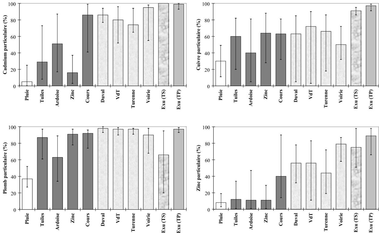
**Figure IV.10 :** Pourcentage de Cd, de Cu, de Pb et de Zn sous forme particulaire dans les eaux de ruissellement prélevées par temps de pluie : comparaison avec la pluie et les eaux de temps sec : médiane, déciles inférieur et supérieur
