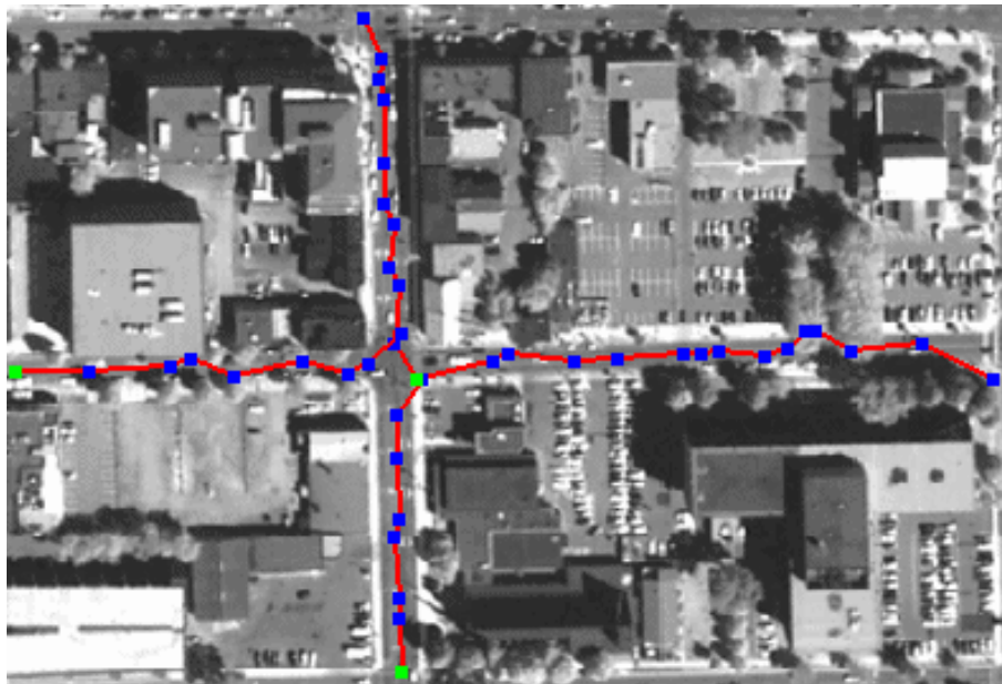
FIG. 3.6: polygones extraites par l'algorithme de suivi de rues. Les points verts correspondent aux amorces fournies par l'opérateur, les points bleus ont été extraits par l'algorithme de suivi.
