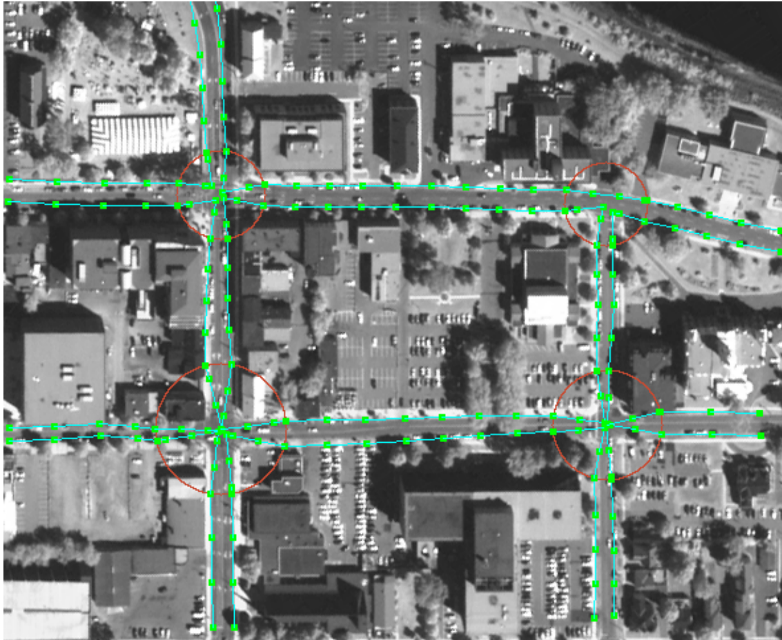
FIG. 5.20: initialisation des intersections après l'extraction des tronçons à bords parallèles
