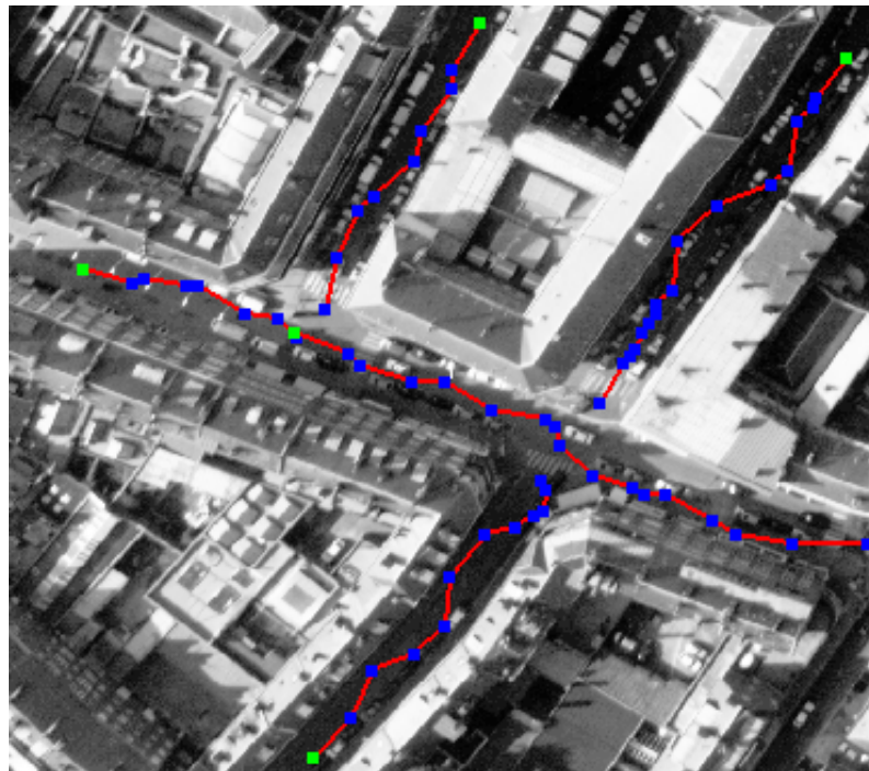
FIG. 5.26: après l'extraction de polygones par l'algorithme de suivi
