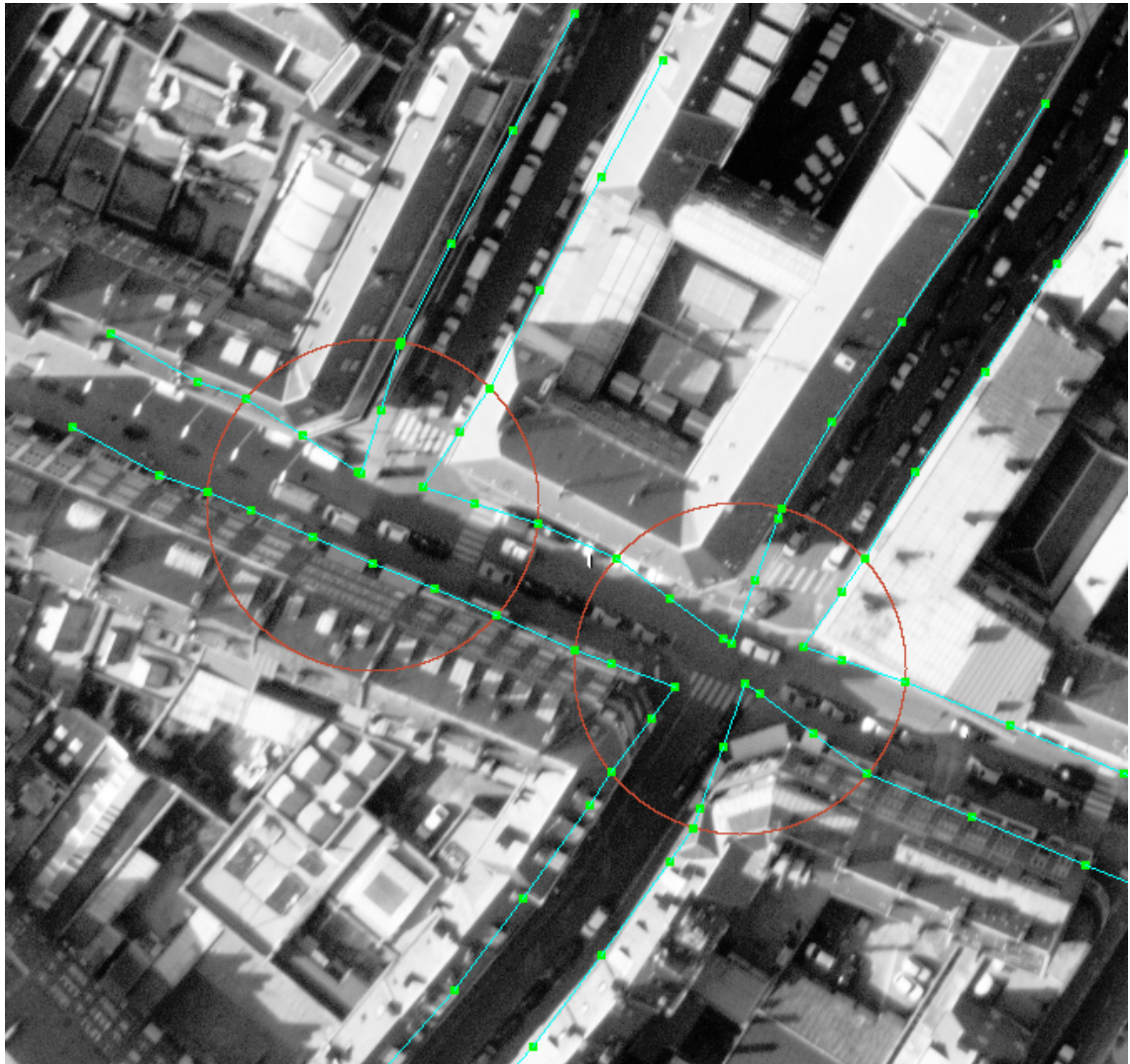
FIG. 5.28: initialisation des intersections après l'extraction des tronçons à bords parallèles
