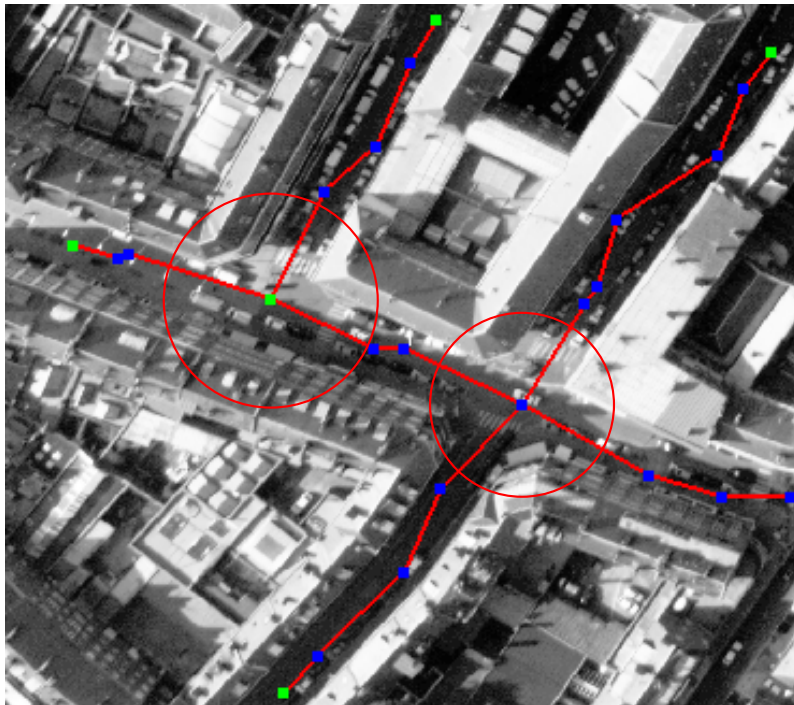
(b) après sous-échantillonnage du graphe topologique
