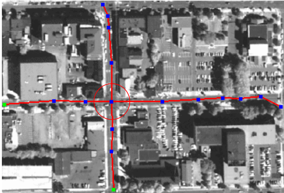
(b) obtention du graphe complet sous-échantillonné à partir des polygones extraits par l'algorithme de suivi
