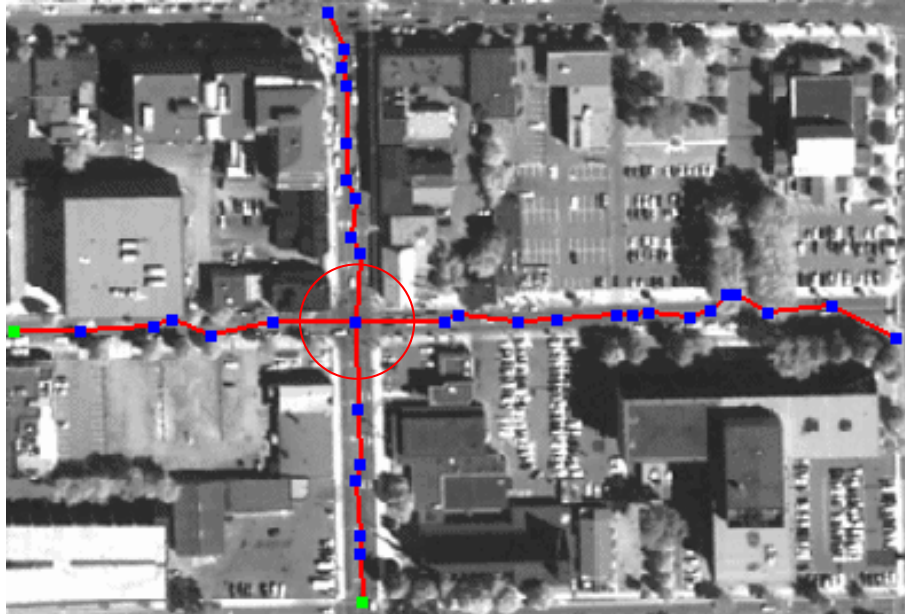
(a) obtention du graphe complet à partir des polygones extraits par l'algorithme de suivi
