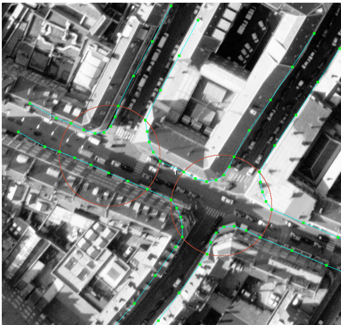
FIG. 5.29: résultat final après l'extraction des intersections
