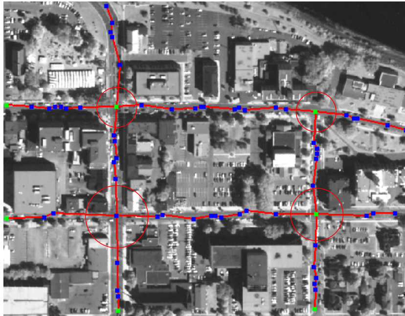
FIG. 5.18: obtention du graphe topologique
