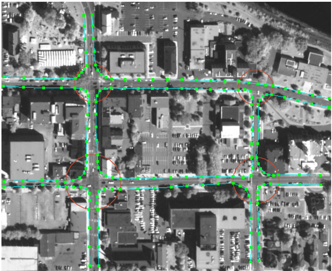
FIG. 5.21: résultat final après l'extraction des intersections
