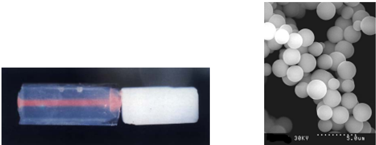
FIG. 3 – aérogel monolithiques et en granulés
