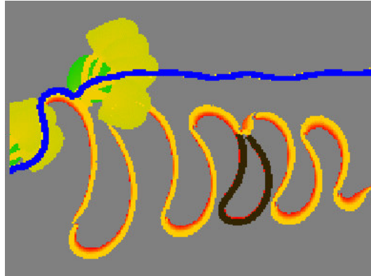
FIG. 5.19 – Avulsion réussie et nouveau cours du chenal sur la plaine d'inondation La plaine d'inondation, représentée en vue aérienne, mesure 6 km de long pour 3 km de large. On peut observer en kaki, un bouchon d'argile résultant d'un recouvrement par tangence plus ancien.
