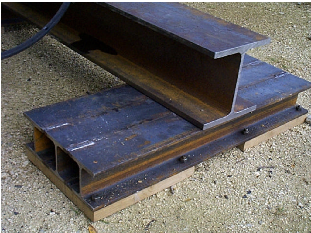
Photo 3 : Vue d'un patin avec ses deux surfaces d'appui en bois.
