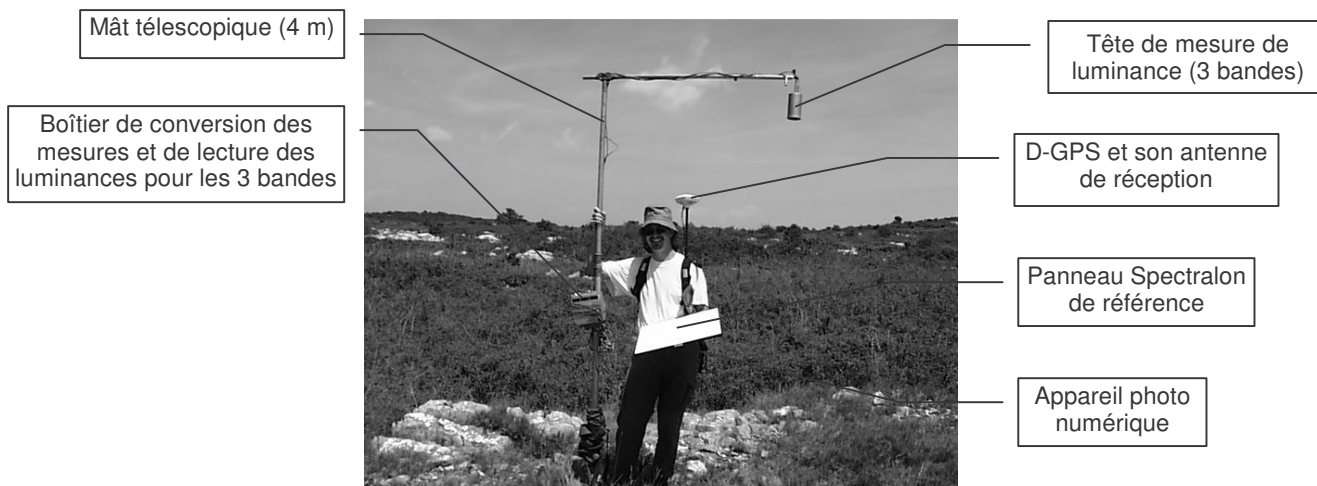
Figure 4. Instruments utilisés pour la mesure de réflectance d'un couvert
