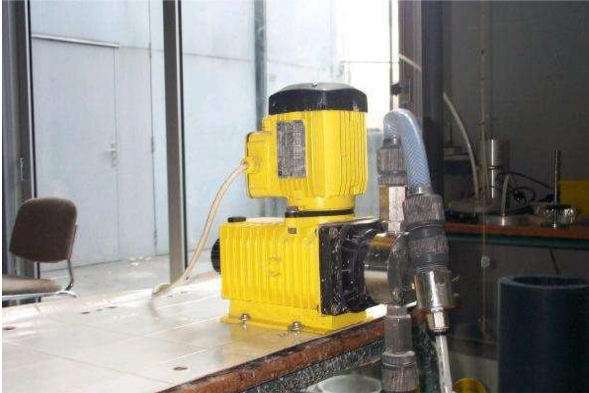
*Figure 3-2 Vue de la pompe à membrane*
