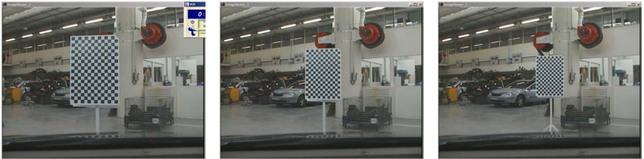
Figure 60 : La mire de calibration
