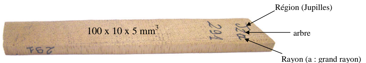
Figure 34 : Échantillon utilisé pour mesurer l'infradensité
