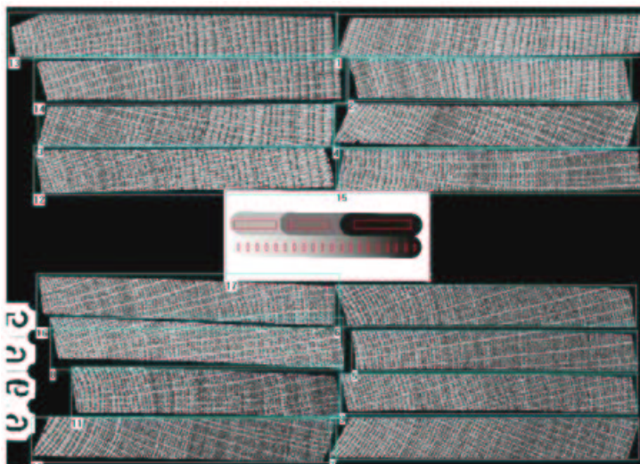
Figure 39 : Radiographie traitée par le logiciel CERD : ici, les images radiographiques de seize échantillons entourent les images des deux cales de référence
