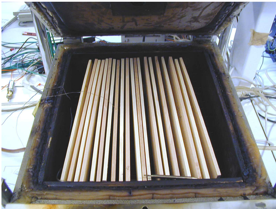
Figure 5-18 : Photo de la disposition des échantillons dans le four expérimental de traitement thermique du CIRAD-Forêt (Photo Patrick Rousset, CIRAD-Forêt ).
