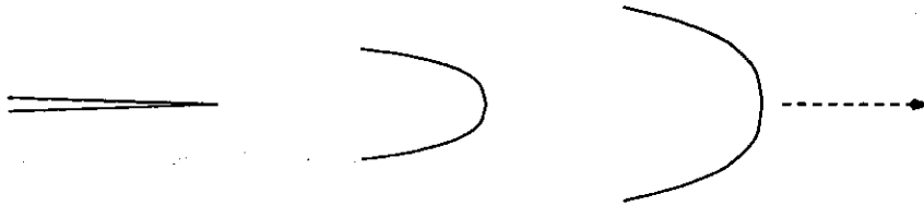
FIG. 1.1-2: Représentation schématique de l'évolution du fond de fissure dans le cas d'une propagation droite. Etat initial, ouverture avant amorçage et ouverture en cours de propagation.
