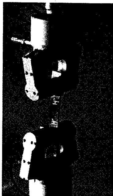
(a) Epreuve non-déformée. Les mors pneumatiques une fois serrés, l'éprouvette est dans une configuration légèrement flambée.
