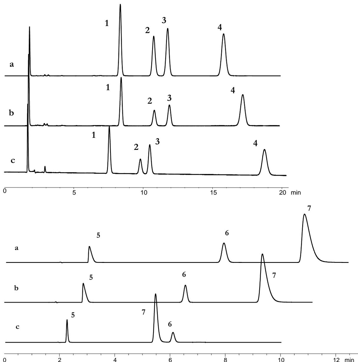
Figure VIII-19 : Chromatogrammes obtenus sur les phases Polaris (a) Ether (P18\_5), (b) C18-A (P18\_3) et (c) Amide C18 (P18\_4) avec le méthanol pour modificateur organique ; (1), butylbenzène, (2), o-terphényle, (3), pentylbenzène, (4) triphénylène, (5) benzylamine, (6), caféine et (7) strychnine.
