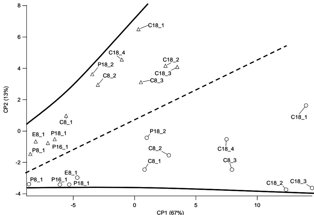
Figure V-3 : « Score plot » CP1-CP2 sur les couples colonne/solvant issus de tous les facteurs de rétention ; la forme en V et la bissectrice correspondante sont schématisées respectivement en traits pleins et pointillés.
