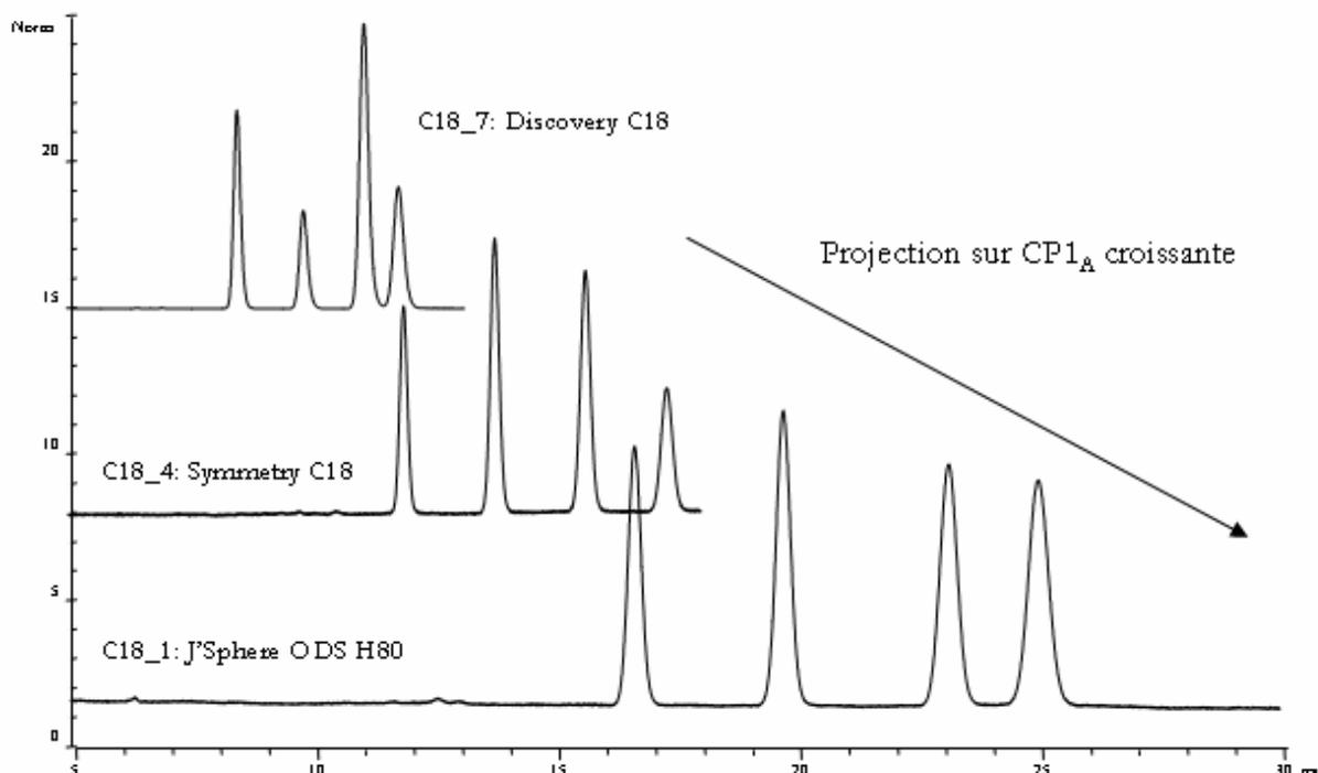
**Figure VIII-4 : Chromatogrammes des neutres de Tanaka obtenus sur trois phases stationnaires C18 avec l'acétonitrile pour modificateur organique ; ordre de rétention : butylbenzène, *o*-terphényle, triphénylène et pentylbenzène.**
