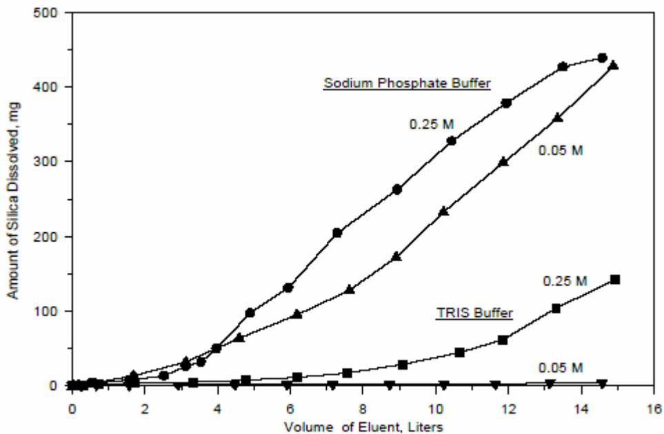
A titre d'ultime illustration, citons l'effet de la nature du tampon sur la stabilité d'une phase stationnaire Zorbax Extend, conçue pour un fonctionnement à pH élevé [119].
