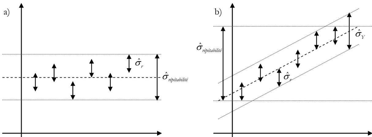
Figure VII-2 : Schématisation des différents types d'erreur a) erreurs purement aléatoires, b) présence d'un biais ;  $\hat{\sigma}_r$  correspond à la variabilité résiduelle,  $\hat{\sigma}_{\text{répétabilité}}$ , la variabilité de répétabilité du test,  $\hat{\sigma}_Y$  représente l'écart type lié de régression.
