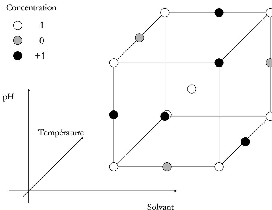
**Figure VII-1 : Représentation du plan D-optimal à 4 facteurs sélectionnés.**
