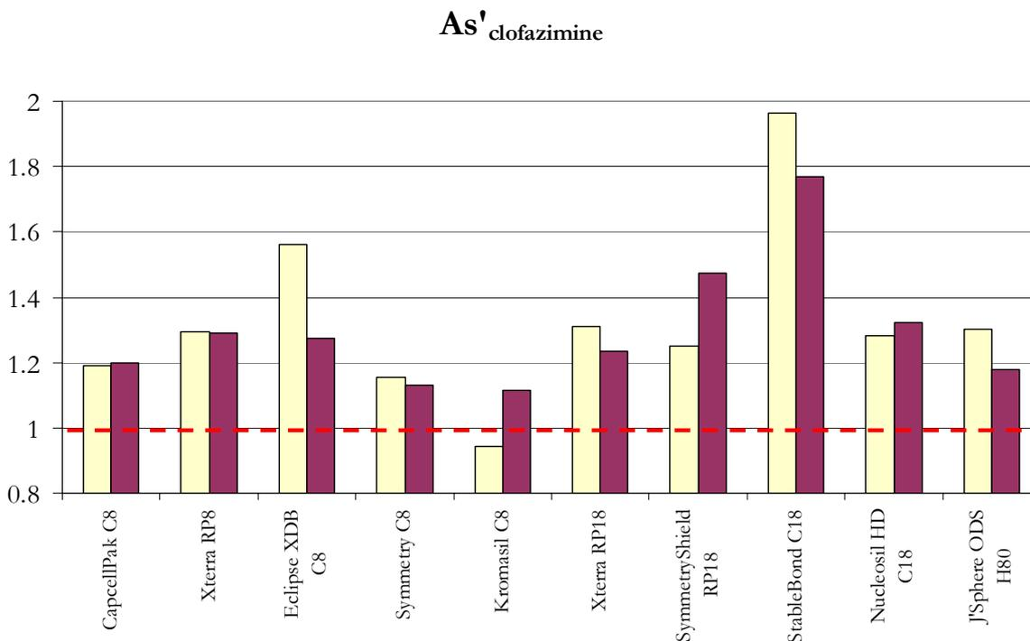
**Figure IV-9 : Moyennes des asymétries de pic pour l'amiodarone et la clofazimine pour chacune des colonnes étudiées avec pour modificateur organique l'acétonitrile (□) et le méthanol (■)**
