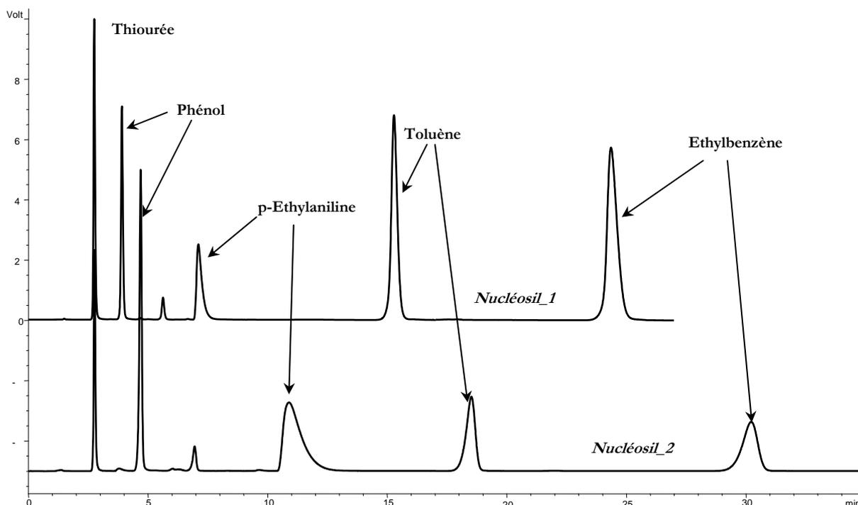
Figure VI-1 : Chromatogrammes obtenus en mélange eau/méthanol 50 : 50 (m/m) pour deux colonnes Nucleosil C18 neuves issues de lots différents.
