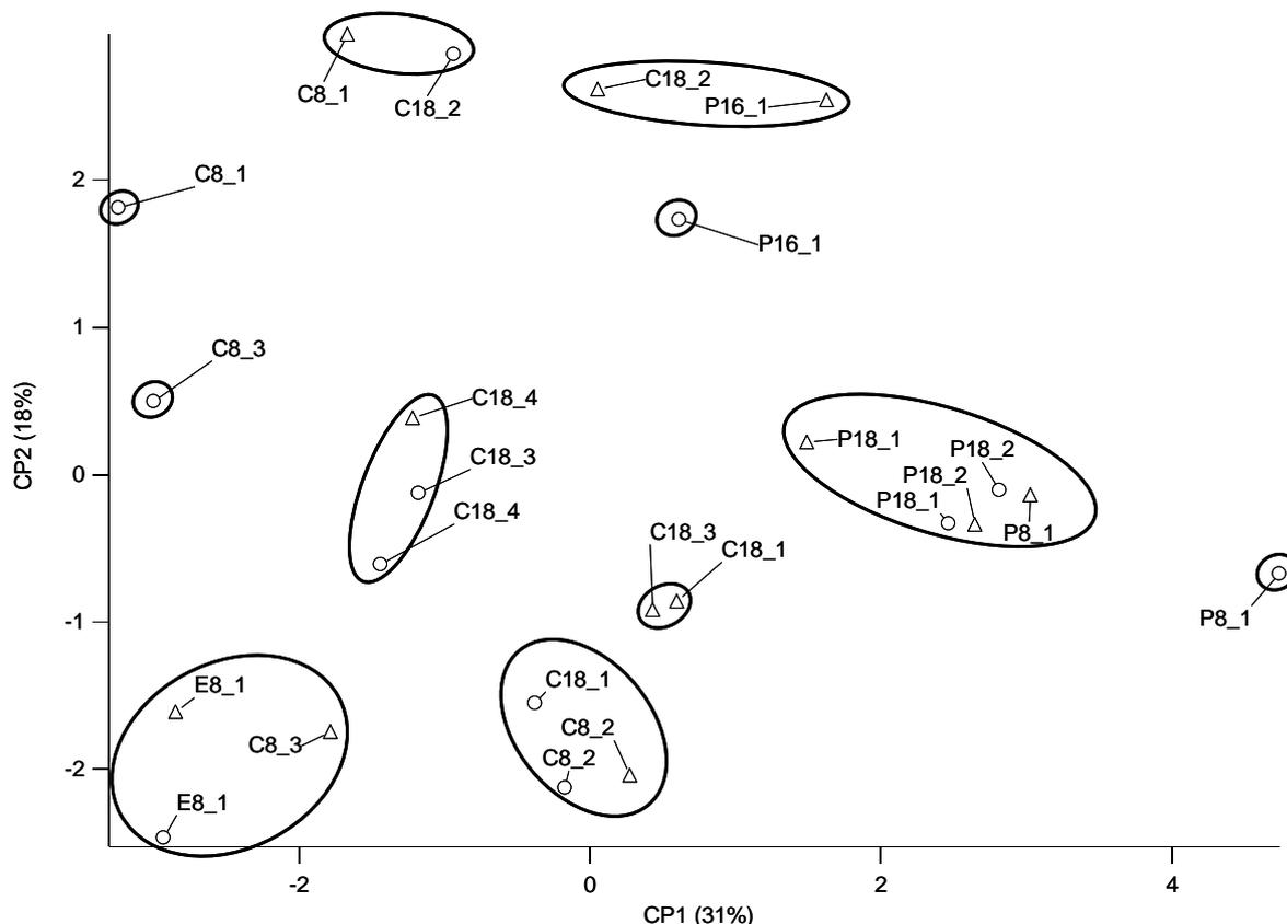
Figure V-12: « Score plot » CP1-CP2 interprété des couples colonne/solvant construits à partir des asymétries de pic au niveaux de teneur en solvant A et D.
