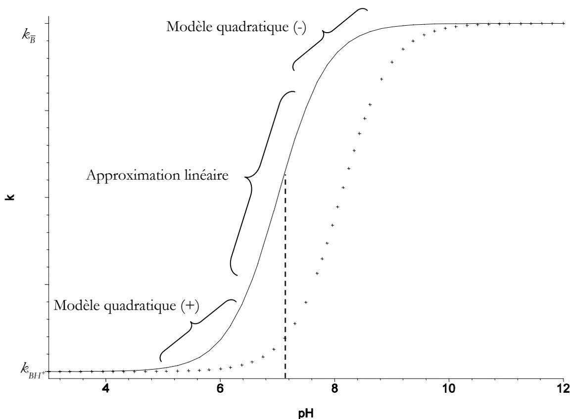
Figure VII-3 : Modélisation du facteur de rétention de composés basiques en fonction du pH apparent de la phase mobile ;  $pK_a$  fixés à 7,0 (trait plein) et à 8,1 (croix), la valeur de pH apparent (fixée pour l'exemple à 7,2) est figurée sous la forme de pointillés.
