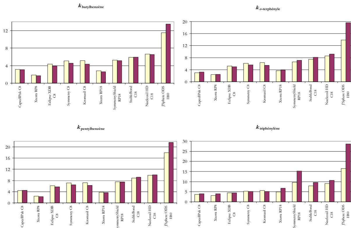
Figure IV-2 : Facteurs de rétention (moyennes des trois injections) pour le butylbenzène, le pentylbenzène, l'*o*-terphényle et le triphénylène pour chaque colonne testée dans l'acétonitrile (□) et le méthanol (■) en tant que modificateur organique.
