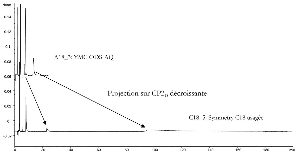
Figure VIII-12 : Chromatogrammes obtenus sur 2 phases stationnaires différant selon CP2 ; A18\_3 est testée dans le méthanol et C18\_5 dans l'acétonitrile ; ordre d'élution : ampicilline, cyanocobalamine, atropine et *d*-tubocurarine
