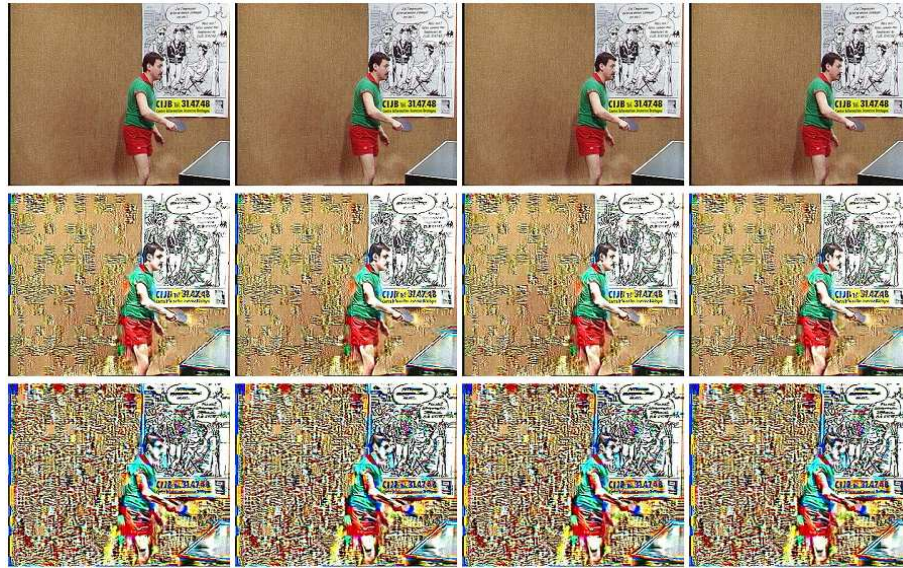
FIG. 28 – Résultats du Waterscrambling sur la séquence ping-pong avec les forces suivantes \alpha . La première ligne représente la séquence originale ( \alpha = 0 ), la seconde ligne représente les résultats avec \alpha = 40 et la dernière ligne utilise \alpha = 60
