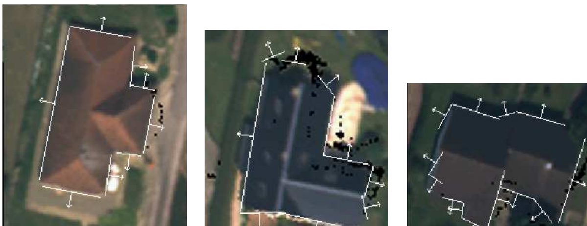
Figure 4.6 - Quelques exemples de discontinuités altimétriques orientées projetées sur une orthophotographie.
