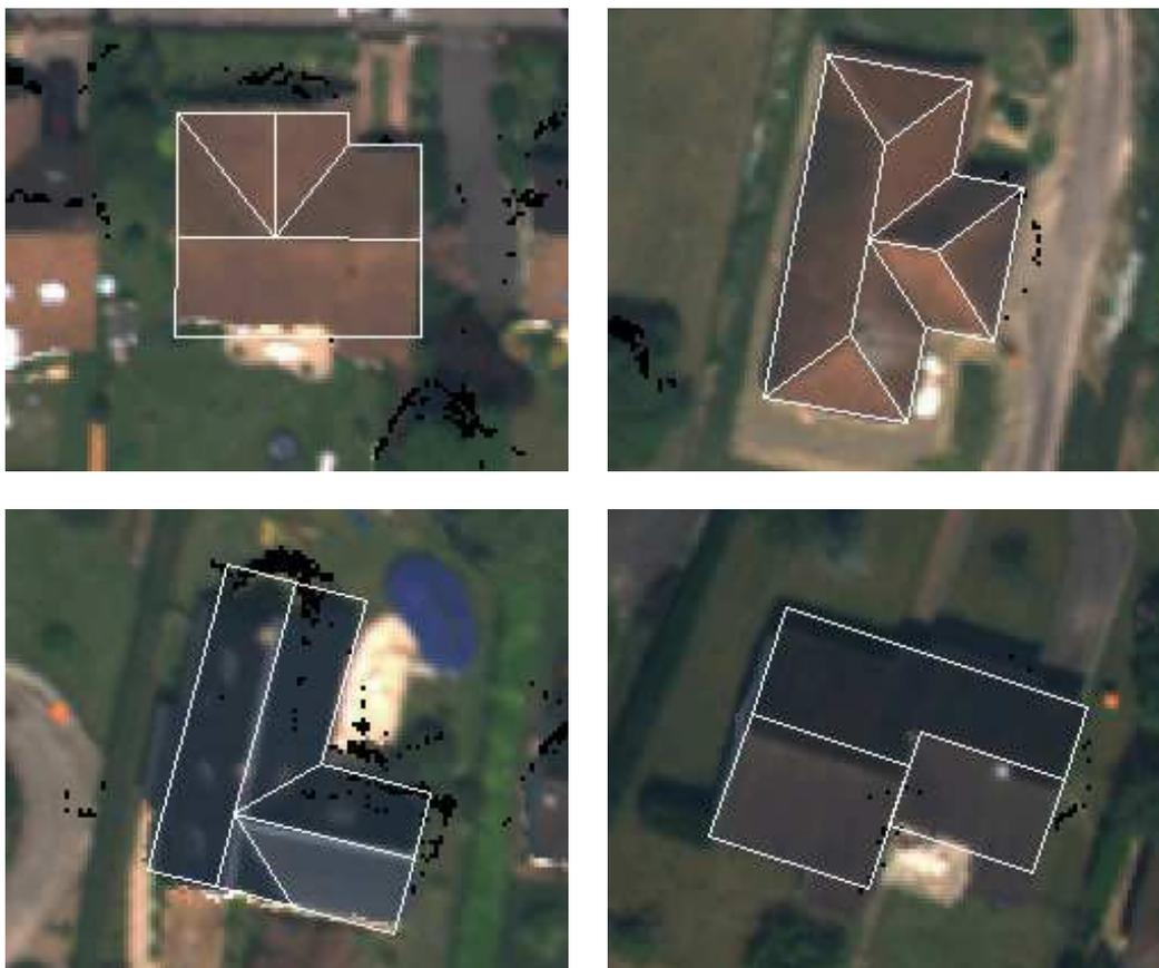
Figure 7.1 - Exemples de bâtiments complexes reconstruits avec succès par l'algorithme.
