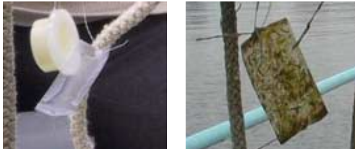
Photo 3 : petite SPMD avant et après 28 jours sans nettoyage dans la Seine à Andrésy, en aval de la station d'épuration Seine-Aval (expérience préliminaire, été 2002, Tusseau-Vuillemin et al., 2003).
