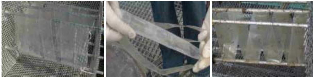
Photo 4 : SPMD avant mise à l'eau (gauche) dans les cages de protection, après 21 jours dans la Marne à Saint Maurice, (février 03, milieu), après 14 jours dans la Seine à Andrézy (avril 03, droite)
