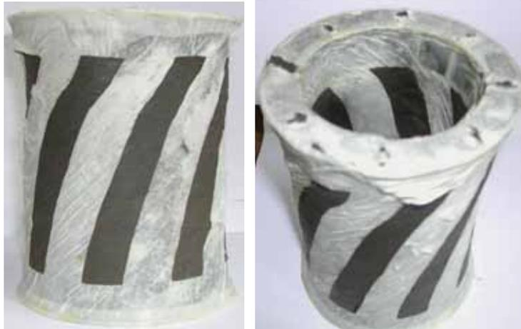
Figure 3.172 Éprouvette déformée
