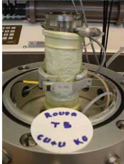
Figure 3.82 Matériel de mesure locale de la variation du diamètre utilisé pour l'essai  $K_0$
