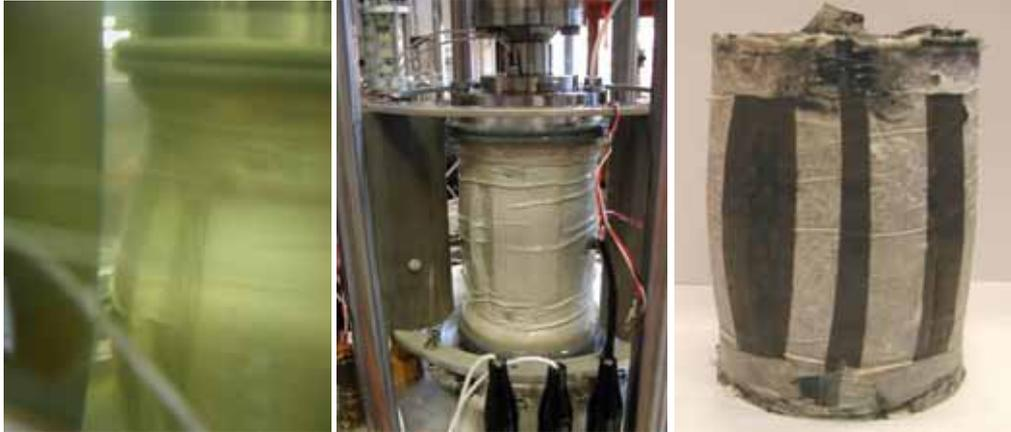
Figure 3.158 Éprouvette déformée
