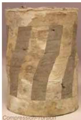
Figure 3.45 Déformée de l'éprouvette après l'essai de compression-torsion
