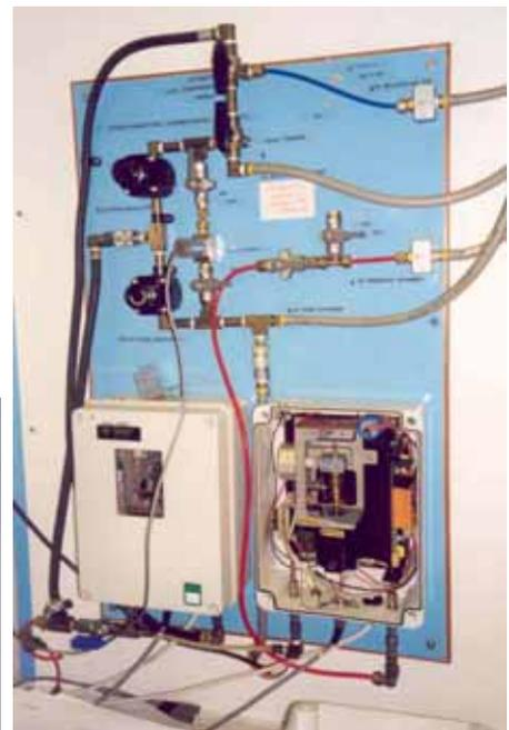
Figure 2.10 Générateur de pression volume CECP et GDS et régulateur de pression de l'Imperial College
