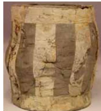
Figure 3.35 Déformée de l'éprouvette
