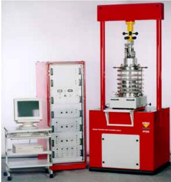
Figure 2.1 Appareil de torsion pour cylindre creux du LCPC
