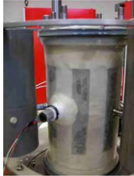
Figure 2.22 Montage du capteur local de pression interstitielle sur l'éprouvette
