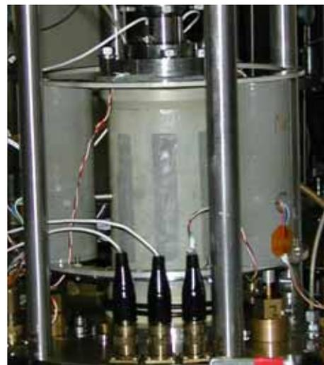
Figure 2.18 Système de capteurs locaux UCD et CECF
