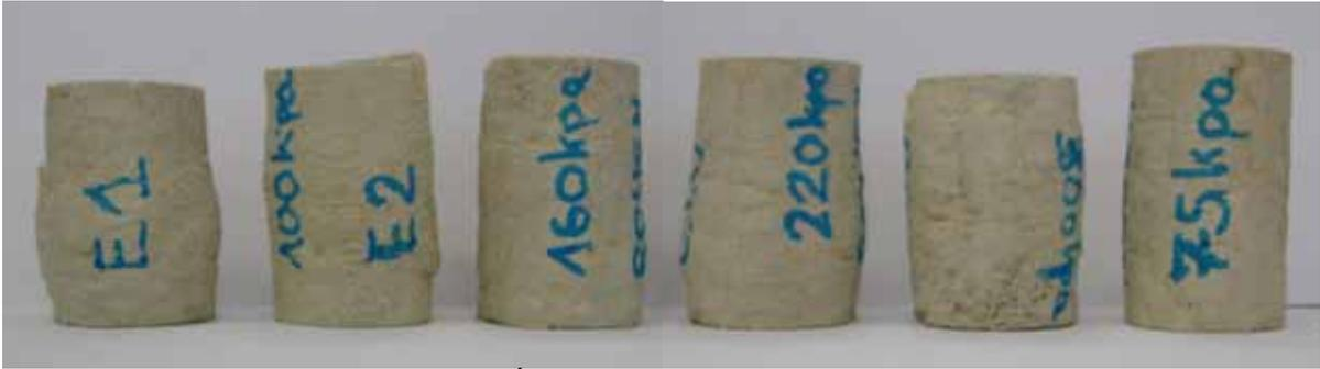
Figure 3.66 Éprouvettes après des essais CU+u
