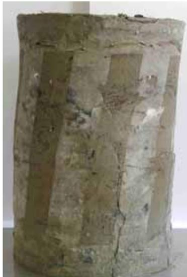
Figure 3.103 Éprouvette déformée
