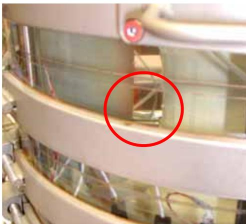
Figure 3.148 Contact entre l'échantillon et le capteur de déformation radiale
