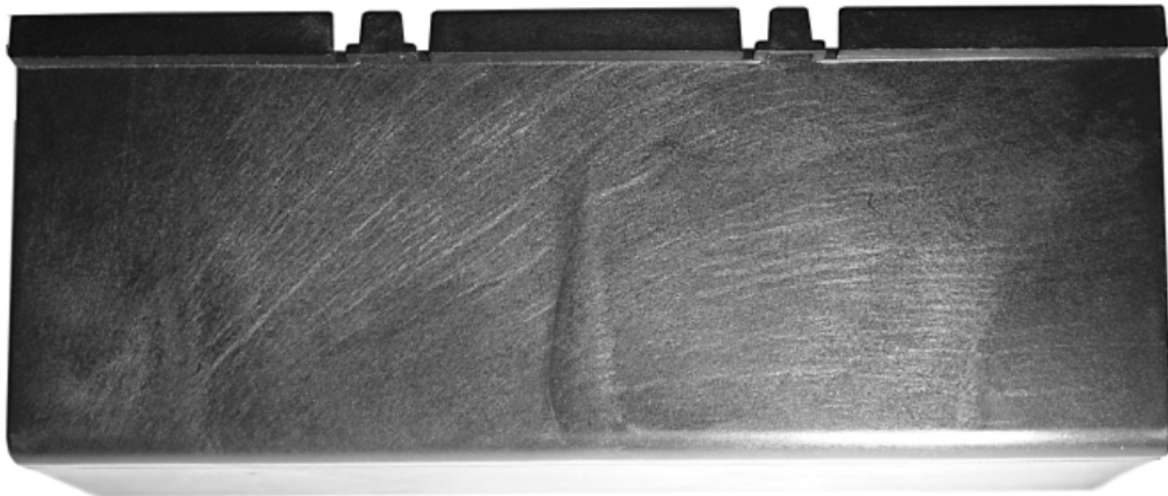
FIG. C.8 – Photographie du flanc de la traverse (avec ce point de vue, l'injection se fait par la gauche)
