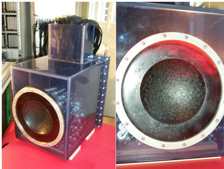
FIG.5.9 – Prototype dédié à la thérapie ultrasonore du cerveau. A gauche l'électronique multivoie et le boîtier contenant les adaptations d'impédances. A droite la distribution semi-aléatoire.
