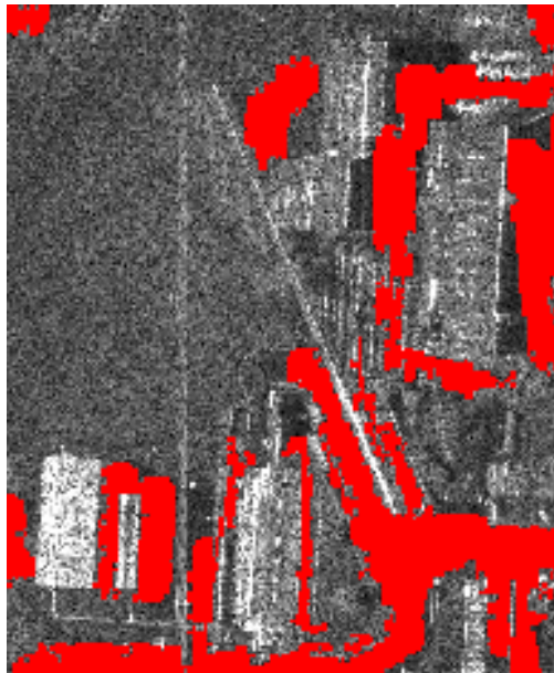
FIG. 6.13 : Superposition des routes détectées (en rouge) sur l'amplitude de l'image RAMSES sur la zone du collège Bayard.
