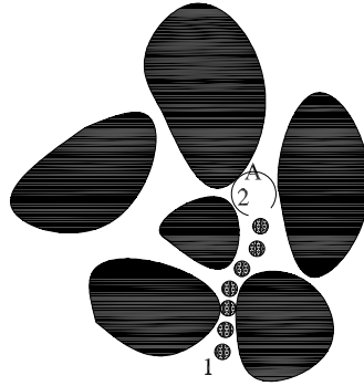
FIG. 4.3 – Description du milieu poreux. Le cercle (1) représente la sphère associée au rayon d'accès et le cercle (2) la sphère associée au rayon propre au point A
