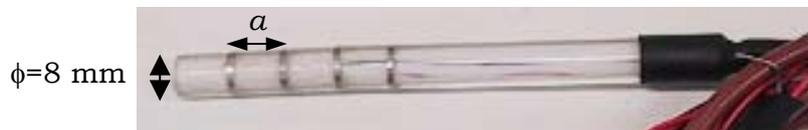
**Figure II-3. Photo de la sonde de conductivité électrique type Wenner ( $a = 5$  mm).**
