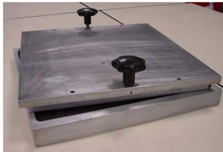
Figure 2.10 – Moule de cuisson des plaques de composite verre/époxy.
