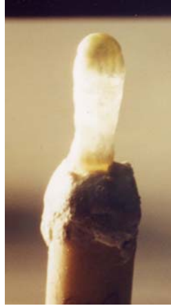
Fig. 2 – Cristal élaboré par la méthode de fusion de zone.
