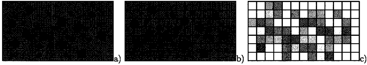
FIG. 3.1 – Représentation schématique de la méthode utilisée a) Microstructure d'un matériau hétérogène b) Superposition d'un maillage d'éléments finis sur la microstructure du matériau hétérogène c) Microstructure avec une porosité locale hétérogène
