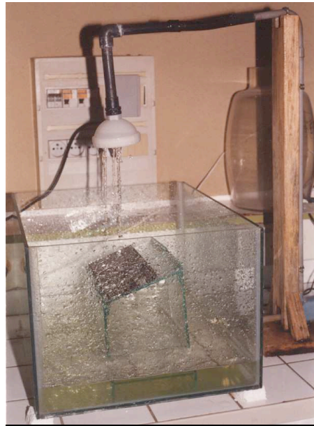
Figure 34: simulation de la phase de pluie
