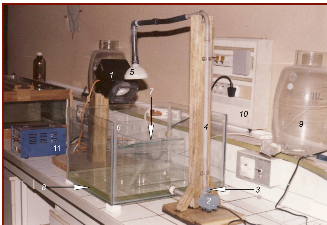
Figure 31: le dispositif pour la simulation des intempéries
