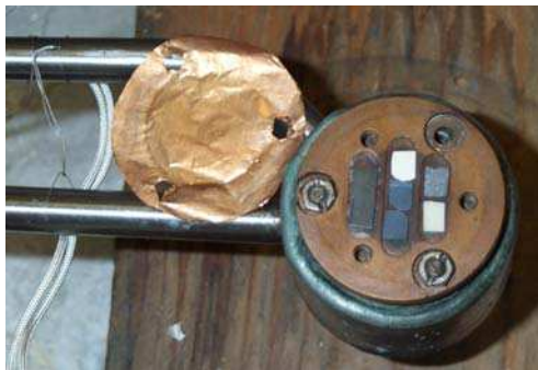
Figure V.21 : Porte-échantillon avec les échantillons de hollandite.
