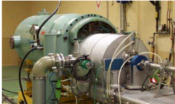
Figure V.20 : Accélérateur Van de Graaff du LSI.
