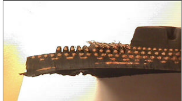
Photo. 5.2. : vue en coupe d'une section de BdR de pneu attaquée par jet d'eau H.P.
