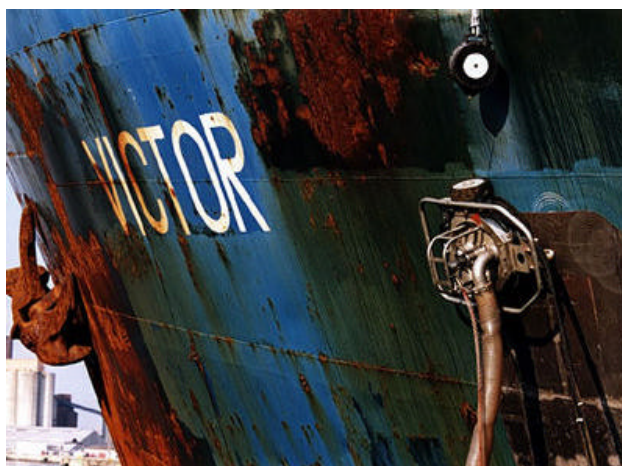
Photo.1.3. : Décapage de coque de navire (source société Rivard)
