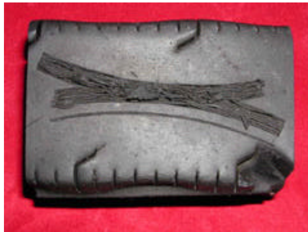
Photo.3.6. : séparation copeaux / échantillon avec superposition de saignées
