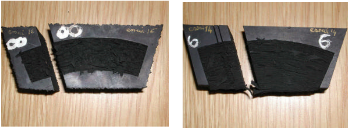
Photo.3.5. : séparation copeaux / échantillon en fonction du pas entre stries
