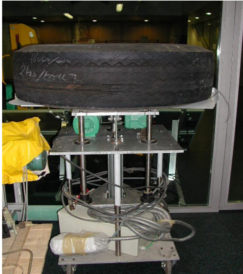
Photo. 5.4. : Enlèvement de gomme sur le pneu posé sur son système rotatif
