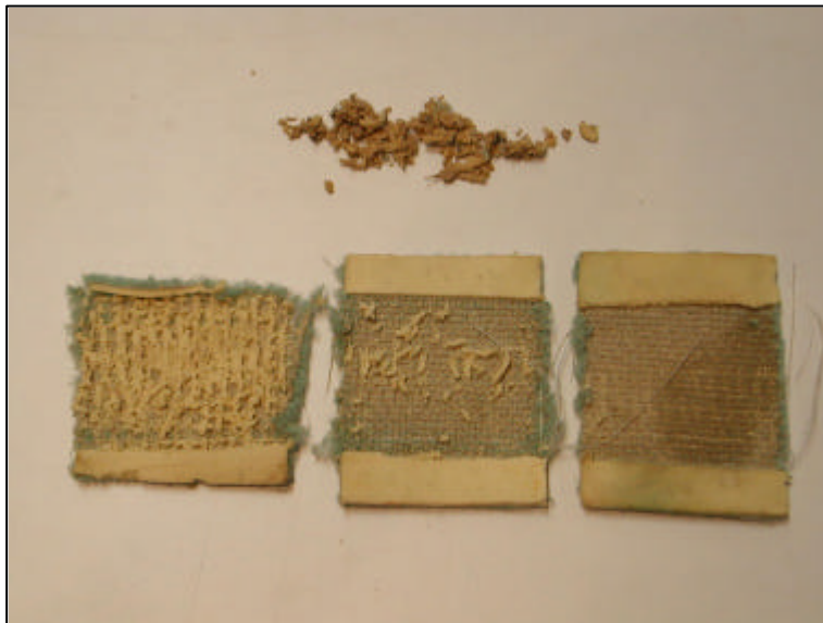
Photo1.6. : Elimination du latex sur une moquette usagée (source ENSAM)
