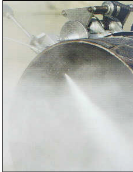
Photo.1.2. : découpe d'éléments de structure de puits de pétrole (document société Rivard)
