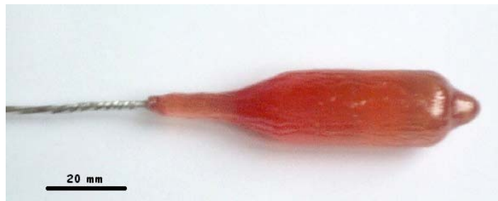
Figure 4. 29. Cristal de GdAlO_3:Yb^{3+} 2 % élaboré par la méthode de Czochralski.
