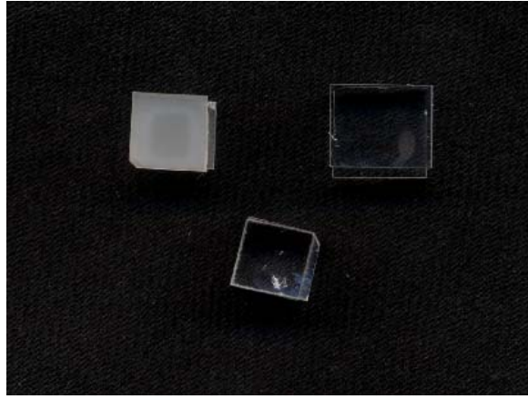
Figure 2. 36 Exemples de cristaux à différents stades du procédé de soudage. En haut à gauche, on devine, au travers de la surface doucie, les anneaux de Newton en périphérie de la zone de contact optique.
