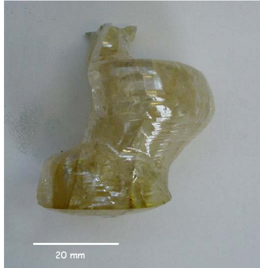
Figure 4. 28. Cristal de GdVO_4:Yb^{3+} 2 % élaboré par la méthode de Czochralski.
