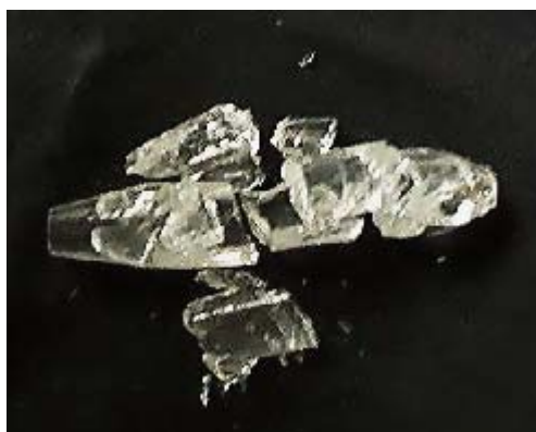
Figure 3. 3 Canon de \text{Sr}_3\text{Y}(\text{BO}_3)_3 fracturé.
