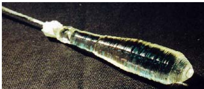
Figure 3. 2. Canon monocristallin de \text{Sr}_3\text{Y}(\text{BO}_3)_3:\text{Yb}^{3+} 13.7 at. % élaboré par la méthode de croissance Czochralski sur tige d'iridium.
