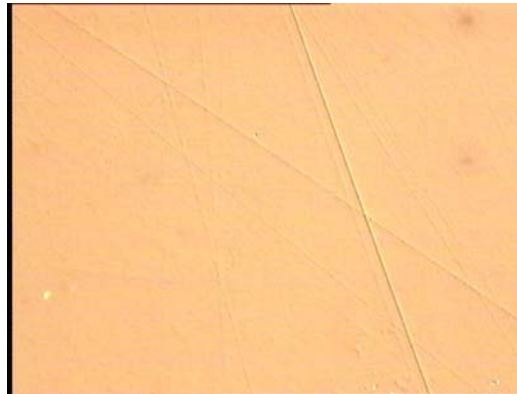
Figure 2.25 Vue microscopique d'une surface de YCOB polie au diamant. On visualise les sillons laissés par l'abrasif dans la chair du cristal.
