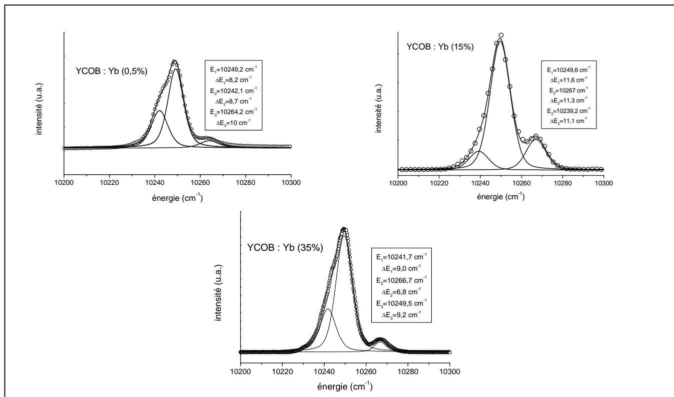
Figure III- 15 : raie fondamentale d'absorption de l'ion  $\text{Yb}^{3+}$  dans le YCOB en fonction de la concentration en ytterbium
