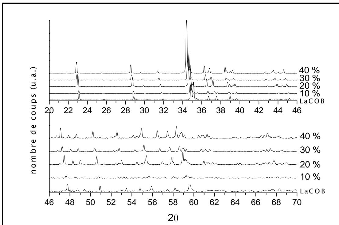
Figure I- 24 : diagramme de diffraction des rayons X des composés Sr/LaCOB
