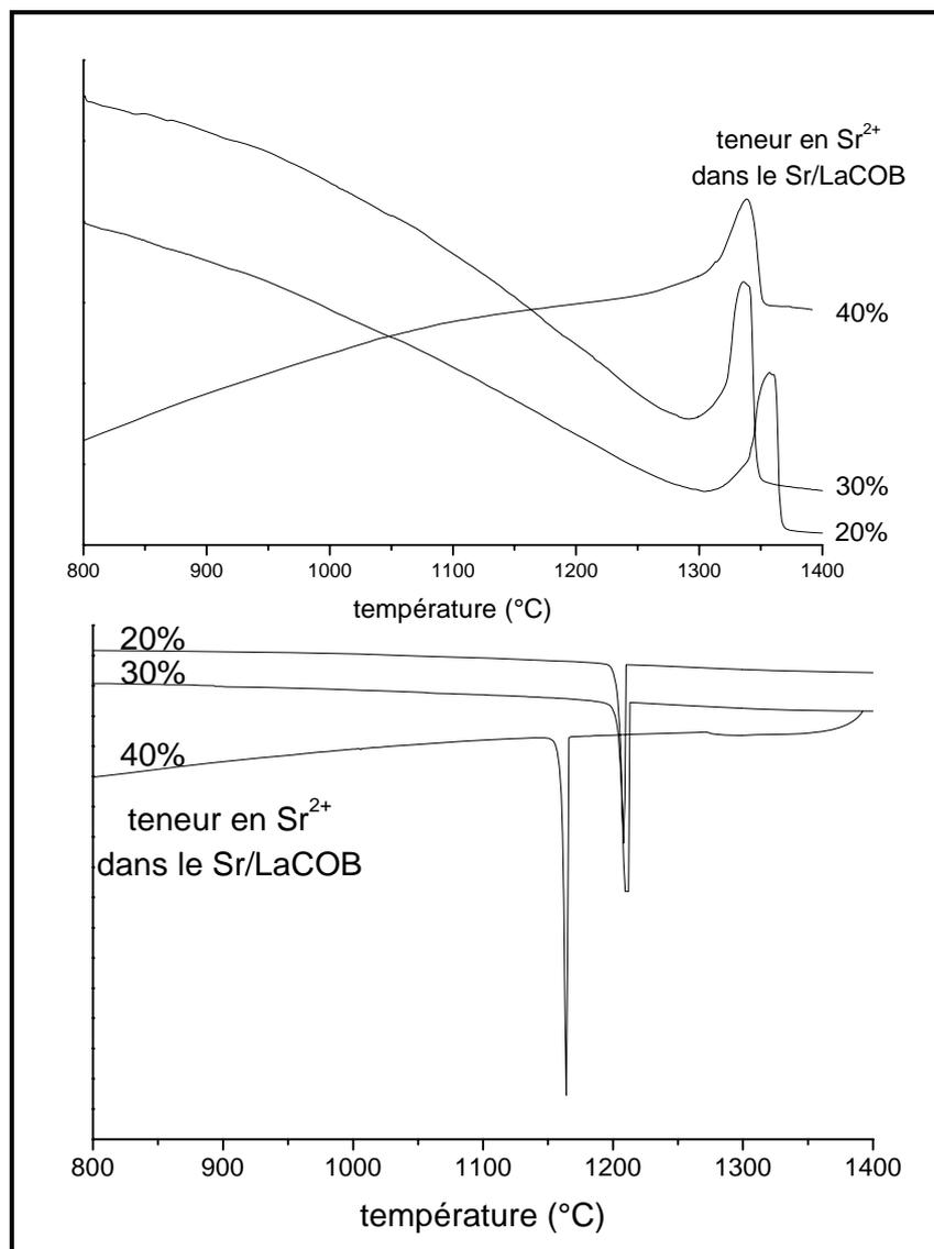
Figure I- 26 : analyses thermiques différentielles des composés Sr/LaCOB a) montée en température b) descente en température
