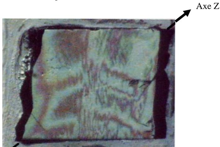
**Figure II- 15 : photo des interférences obtenues sur la lame de LaCOB : Yb normale à Y**
