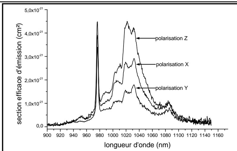
**Figure III- 20 : section efficace d'émission stimulée du YCOB : Yb suivant les polarisations a) X b) Y et c) Z.**
