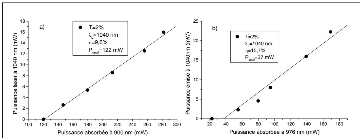
Figure III- 31 : puissance laser obtenue avec le cristal de LaCOB : Yb a) en pompant à 900 nm b) en pompant à 976 nm
