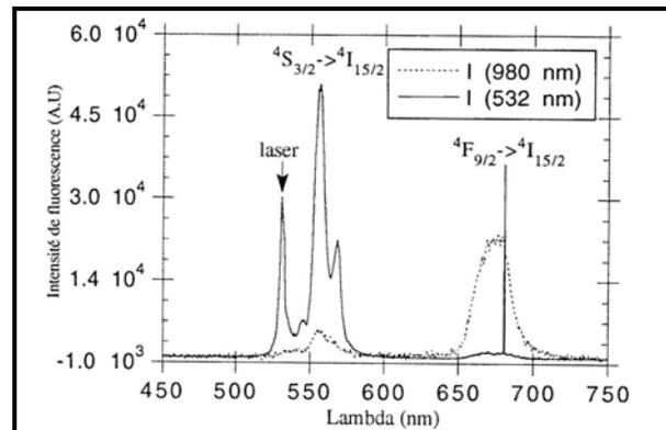
Figure IV- 18 : spectre de fluorescence visible du GdCOB : Yb-Er excité à 532 nm et à 980 nm
