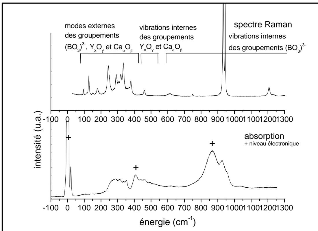
Figure III- 3: spectres d'absorption à basse température d'un cristal de YCOB : Yb (15%) et spectre Raman d'un cristal de YCOB
