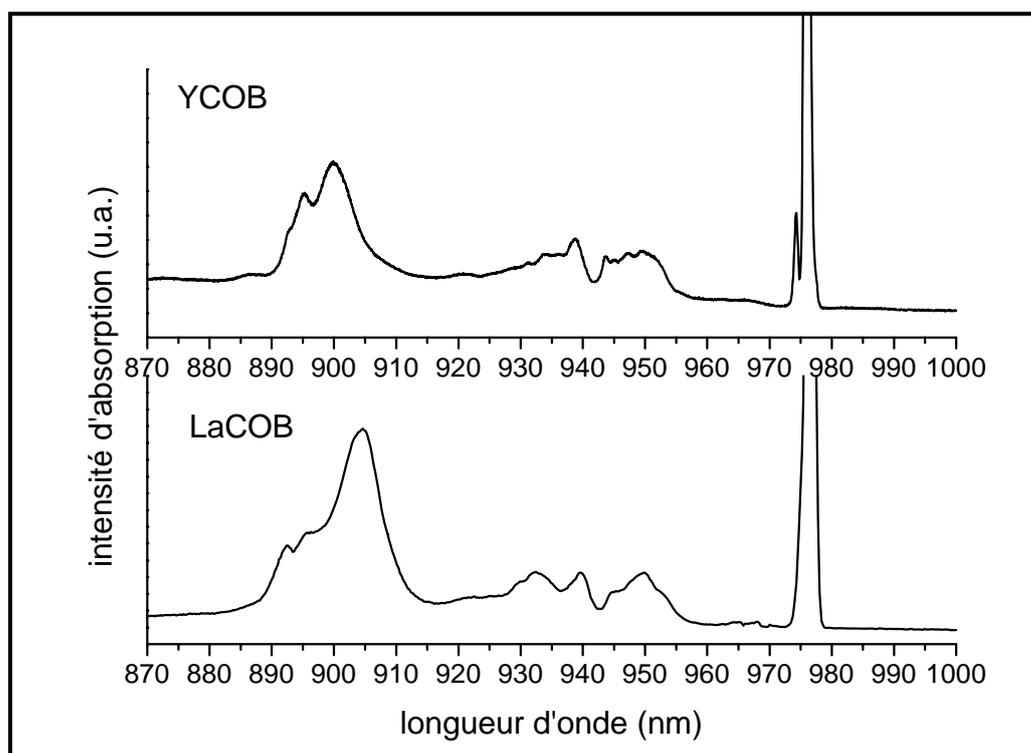
Figure III- 5 : spectres d'absorption à basse température de LaCOB : Yb et de YCOB : Yb
