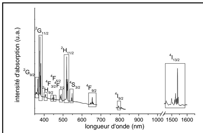
Figure IV- 7 : spectre d'absorption de l'ion  $\text{Er}^{3+}$  dans le GdCOB à basse température
