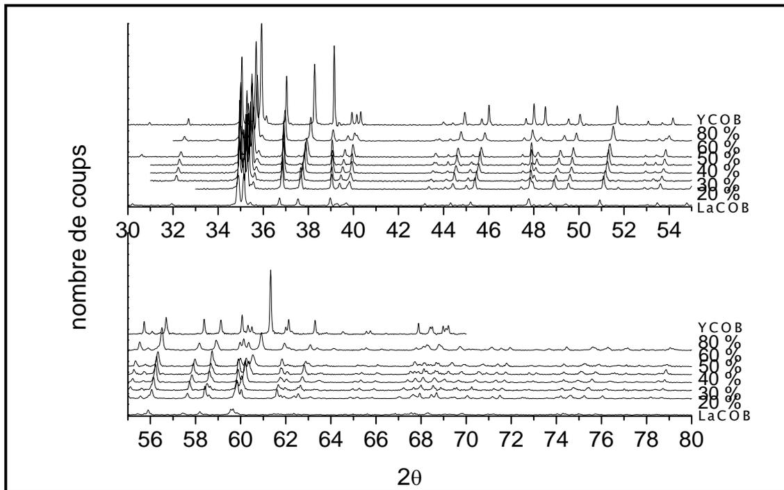
Figure I- 18 : diagramme de diffraction des rayons X des composés Y/LaCOB
