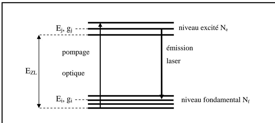
**Figure III- 26 : diagramme d'énergie simplifié d'un laser quasi-3- ou quasi-4-niveaux**
