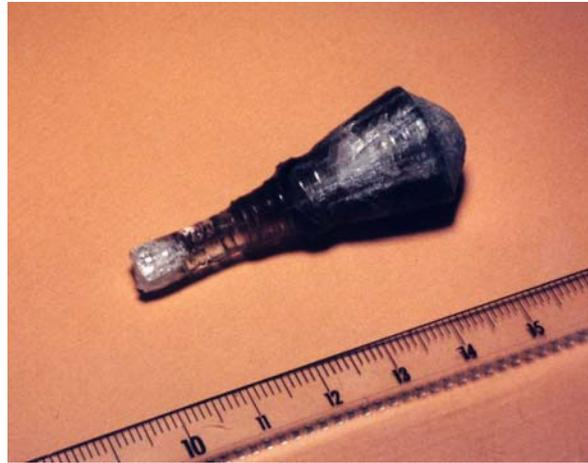
Figure II- 11 : photo du cristal de LaCOB : Yb obtenu lors du deuxième essai
