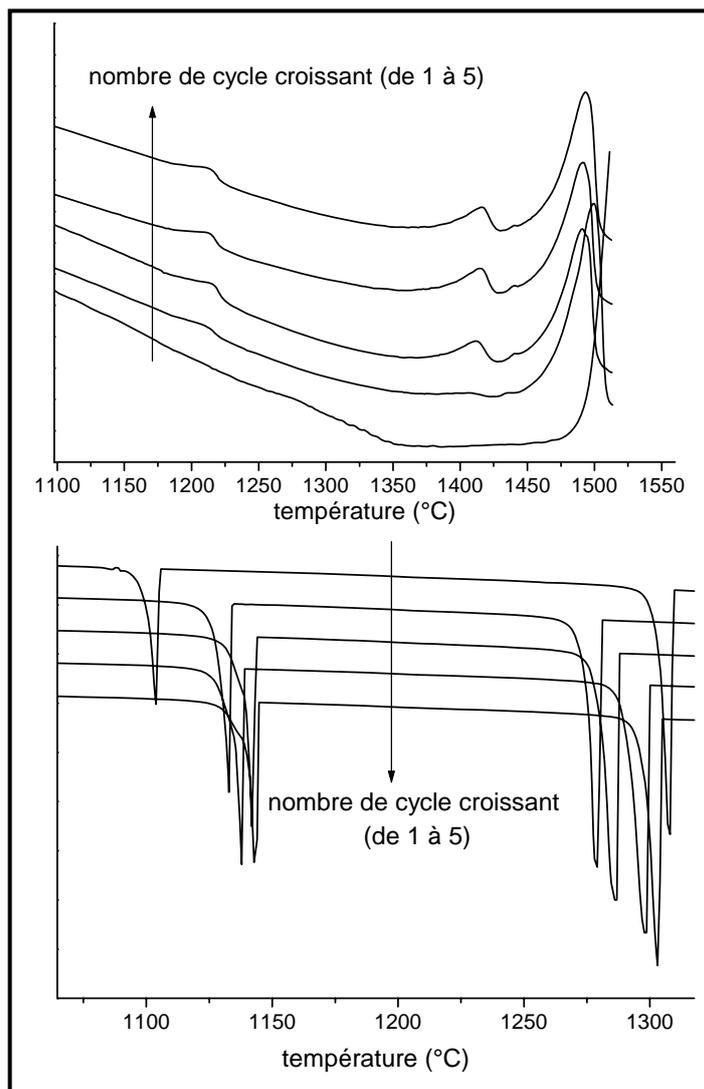
**Figure I- 5: Analyse thermique différentielle de YCOB issu d'un monocristal a) montée en température
