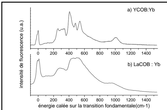
Figure III- 11 : spectre de fluorescence à basse température de a) YCOB et de b) LaCOB : Yb
