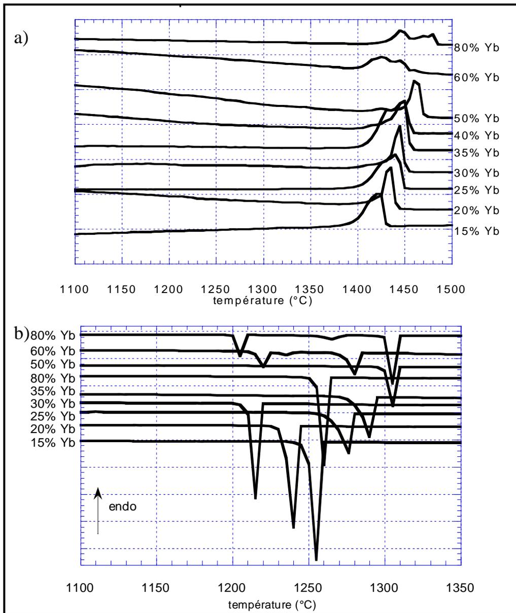
Figure I- 23 : analyses thermiques différentielles des composés Yb/LaCOB a) montée en température b) descente en température
