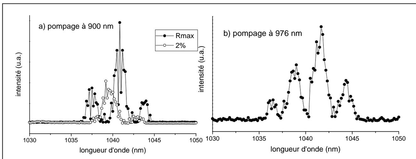
Figure III- 32 : spectre de l'effet laser du LaCOB : Yb a) par pompage à 900 nm b) par pompage à 976 nm
