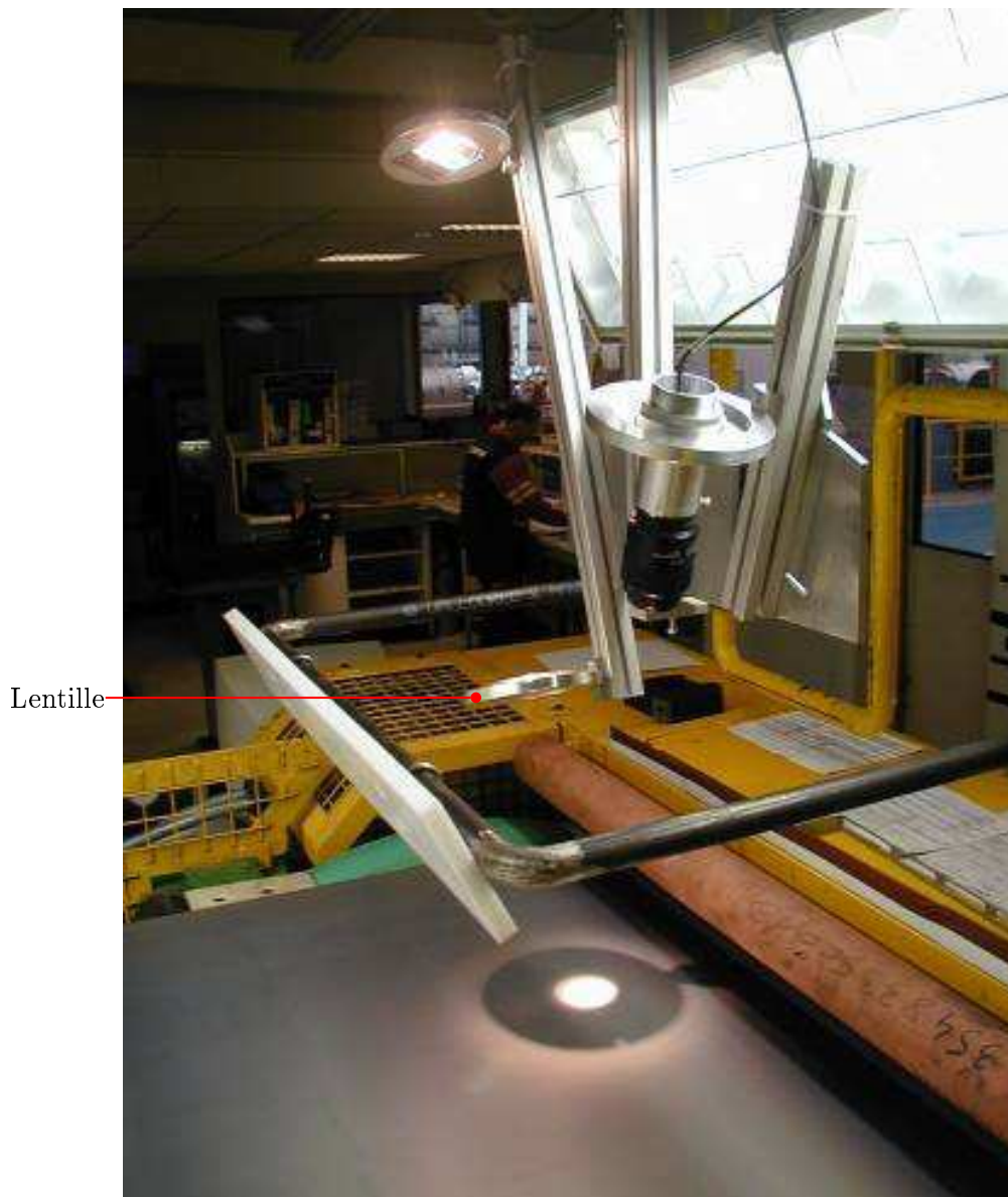
FIG. 5.31.: Prototype d'acquisition en ligne d'images caméra
