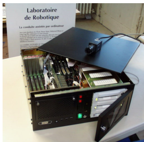
Figure 112: Data Logger et les cartes d'acquisition
