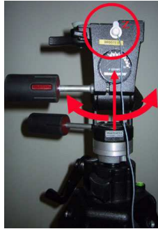
FIG. 3.11 – Mise en place du marqueur pour le test d’orientation
