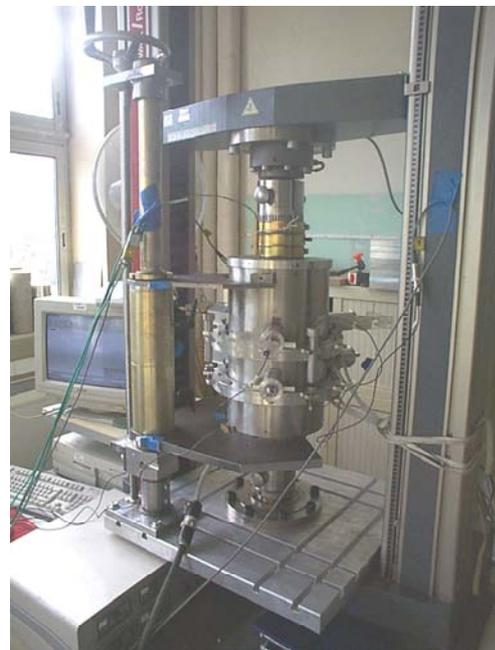
Figure 51 : Dispositif permettant la réalisation d'étude du comportement en la traction directe « à chaud » sur matériau béton.
