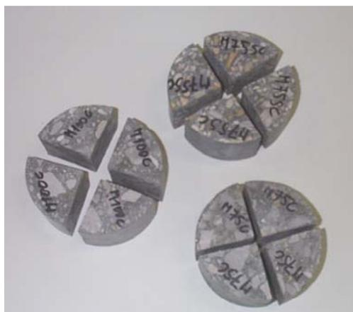
Figure 78 : Eprouvettes utilisées dans l'étude : un quart de Ø 104mm et hauteur de 60mm
