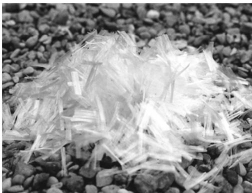
Figure 40. Fibre polypropylène fibrylée FIBERMESCH
