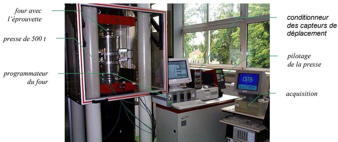
Figure 47 : Ensemble du système d'essais
