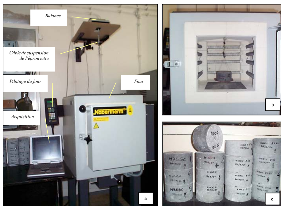
Figure 67: Dispositif d'essais : a) vue sur le four avec une balance positionnée sur le dessus et permettant la suspension des éprouvettes, b) vue de l'éprouvette positionnée sur une grille à l'intérieur du four, c) éprouvettes utilisées dans l'étude : \Phi 104mm et hauteur de 60mm
