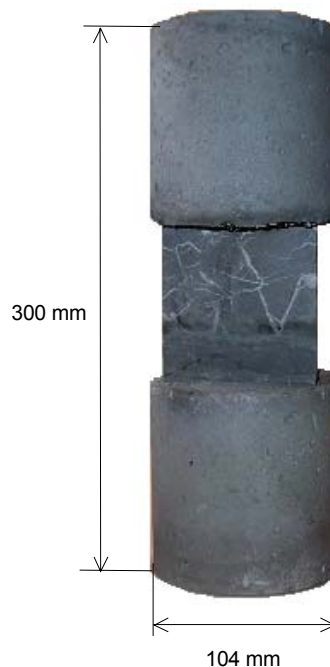
Figure 53 : Etude de la déformation thermique de la roche calcaire
