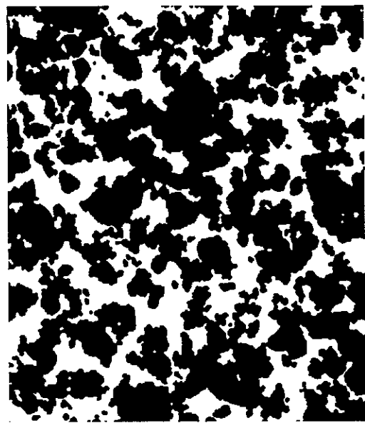
FIG. 1.9 - Microstructure d'un biphase 50% Nickel 50% Argent : 680\mu\text{m} \times 770\mu\text{m}
