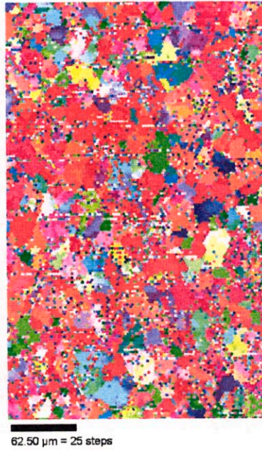
FIG. 2.32 – Carte d'orientation : axe Z dans le repère du cristal
