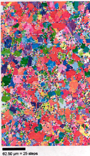
FIG. 2.31 – Carte d'orientation : axe X dans le repère du cristal
